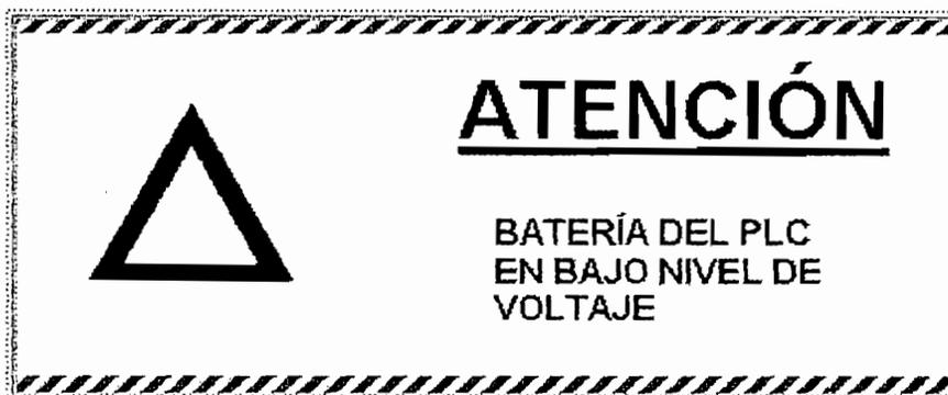
Figura 4.2.3 Ventana “Pilas del PLC en bajo nivel de voltaje”.
