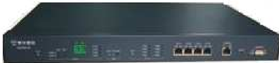
Figura 4.11 Equipo ONT Gigabit Ethernet
