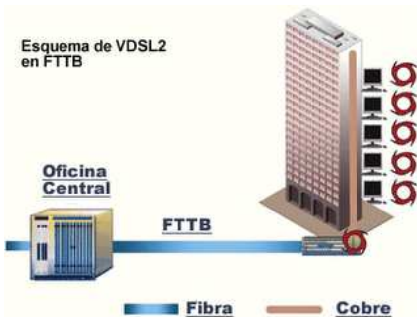
Figura 4.3 Esquema de VDSL2 en FTTB 52
