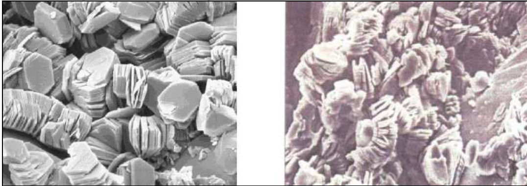
Figura 2.3. Microfotografías de la Caolinita en Medio poroso
