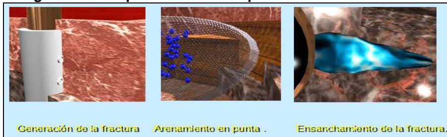
Figura 2.26. Esquematación del proceso de Fracturamiento
