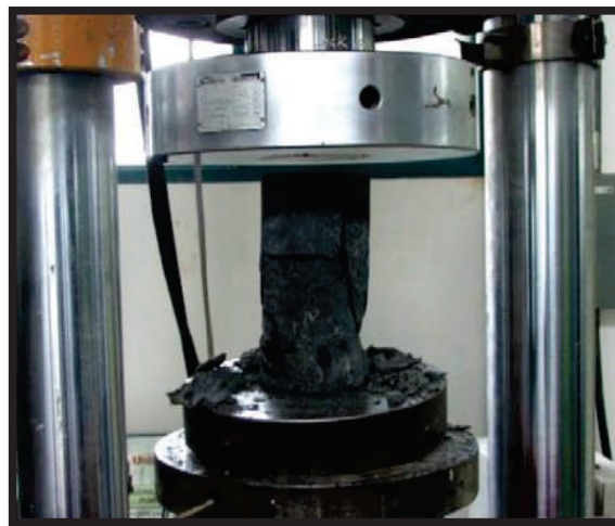
Figura 3.7. Representación de una falla por compresión excéntrica (Lee et al, 2010)
