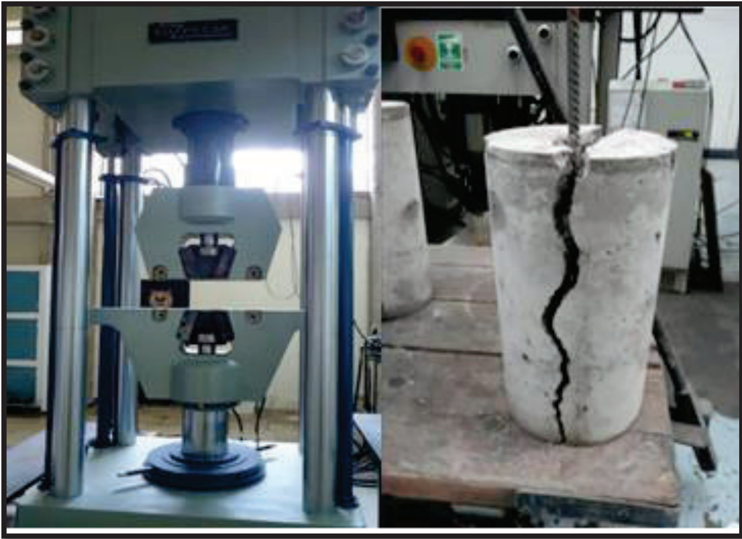
Figura AIII.7. Ensayo de adherencia del hormigón convencional y con ceniza
