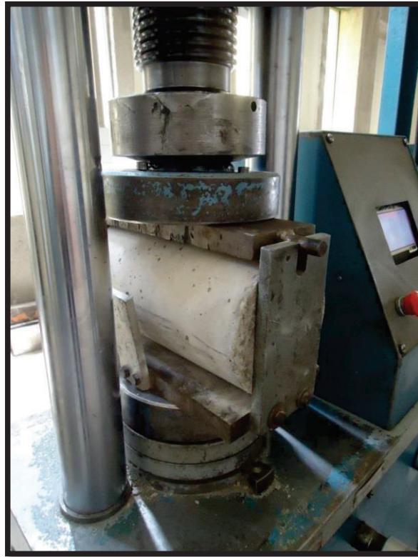
Figura AIII.5. Ensayo de tracción indirecta del hormigón convencional y con ceniza
