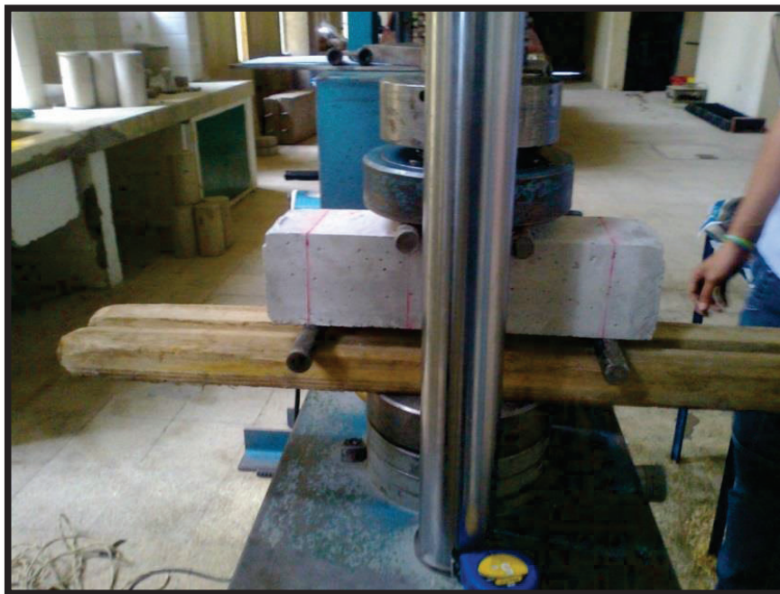
Figura AIII.6. Ensayo de resistencia a la flexión del hormigón convencional y con ceniza, utilizando una viga simple con carga en los tercios
