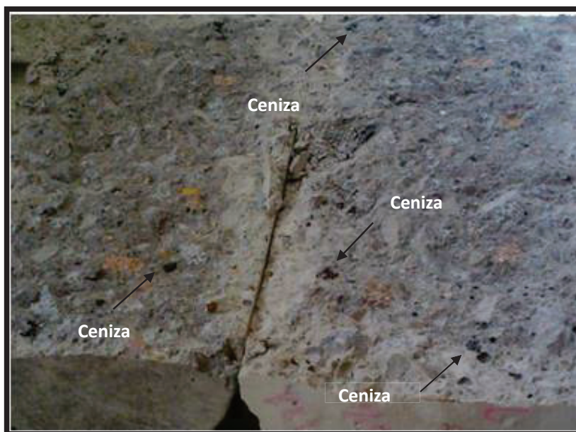
Figura 1.13. Muestra de ceniza proveniente del proceso de incineración encapsulada en una matriz de hormigón (Benavides, 2014)
