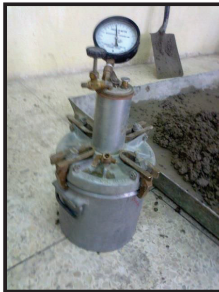
Figura AIII.2. Ensayo contenido de aire del hormigón convencional y con ceniza
