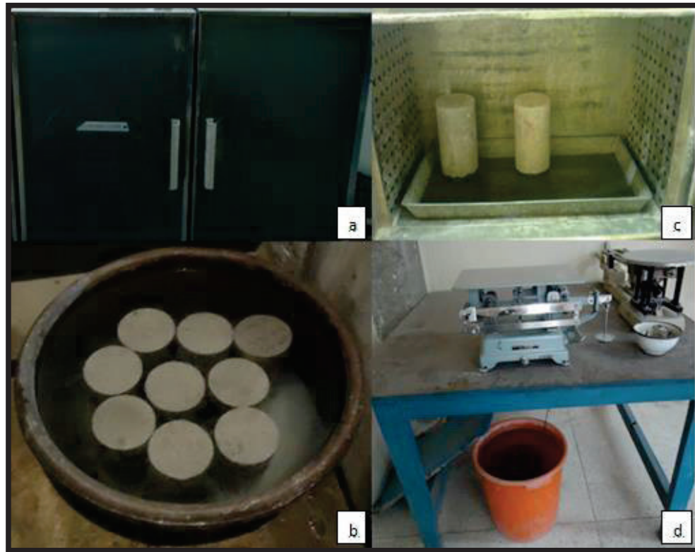
Figura AIII.9. Ensayo de peso específico y absorción de agua del hormigón convencional y con ceniza: a) masa de la probeta después del secado, b) masa de la probeta después del secado y de la inmersión, c) masa de la probeta después de la ebullición, d) masa de la probeta suspendida en agua
