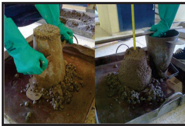
Figura AIII.1. Ensayo de asentamiento del hormigón convencional y con ceniza utilizando el cono de Abrams
