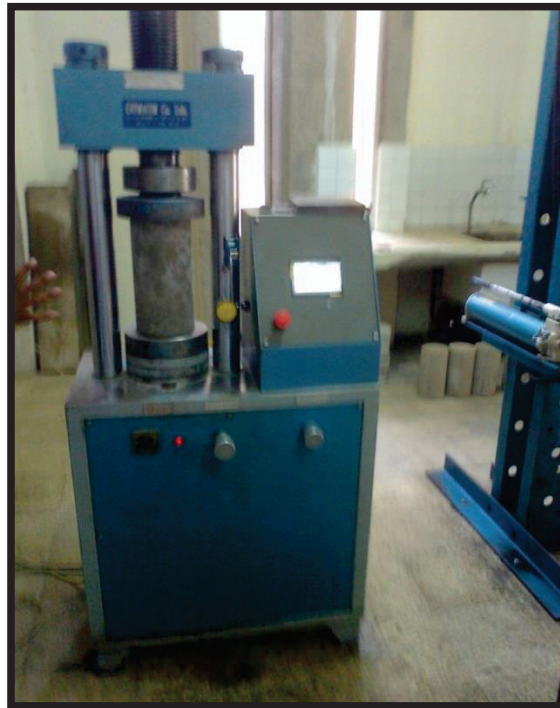
Figura AIII.3. Ensayo de resistencia a la compresión aplicado a una probeta cilíndrica de hormigón convencional y con ceniza
