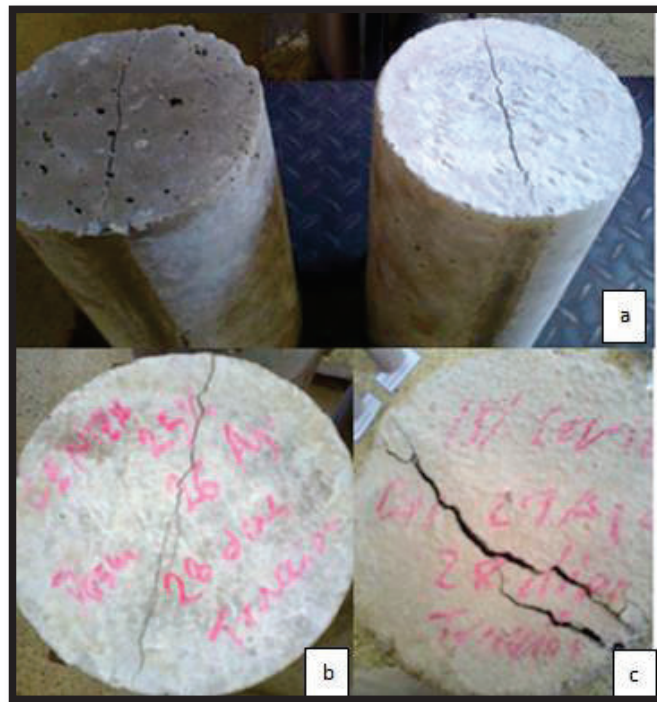
Figura 3.14. Tipos de fisuras anómalas observado en el ensayo de tracción indirecta
