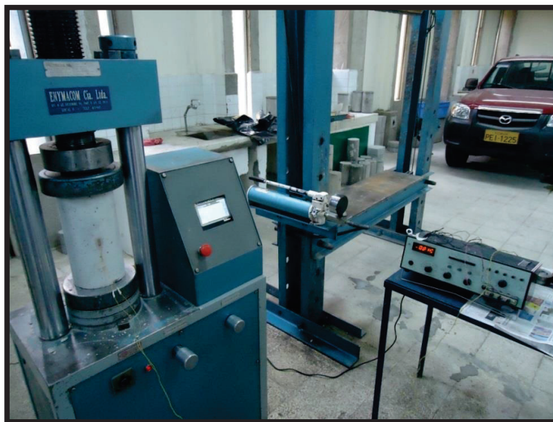
Figura AIII.4. Ensayo de módulo de elasticidad del hormigón convencional y con ceniza
