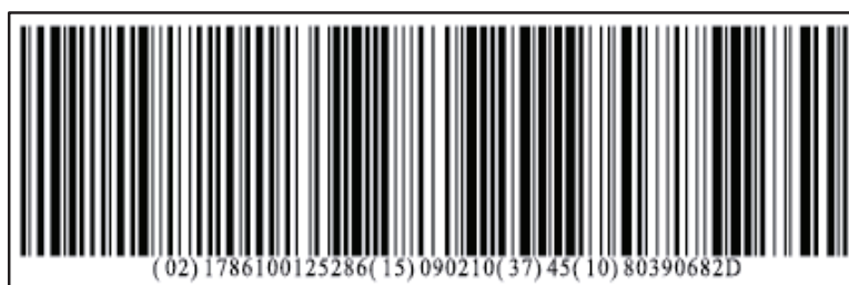
Figura 1 - 8 Estructura del Código GS1-128
