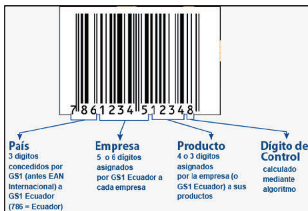
Figura 1 - 5 Estructura del Código GTIN-13
