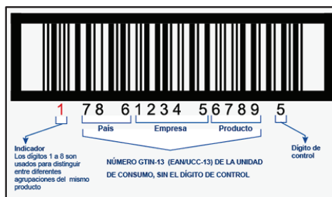
Figura 1 - 7 Estructura del Código GTIN-14 y simbología ITF-14
