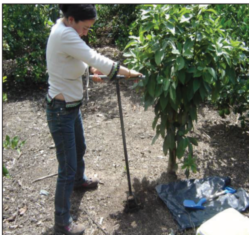
Fotografía No. 46: Toma de muestra de suelo
