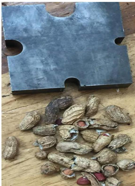
**Figura 2.14:** Probetas después de aplicar el ensayo de corte.
