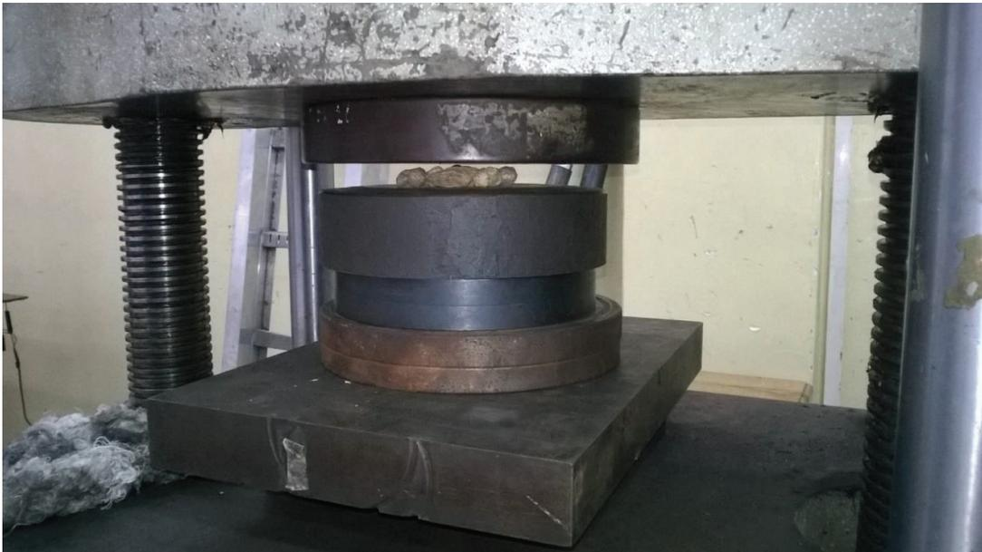
**Figura 2.9:** Ensayo de compresión a varias vainas de Maní.
