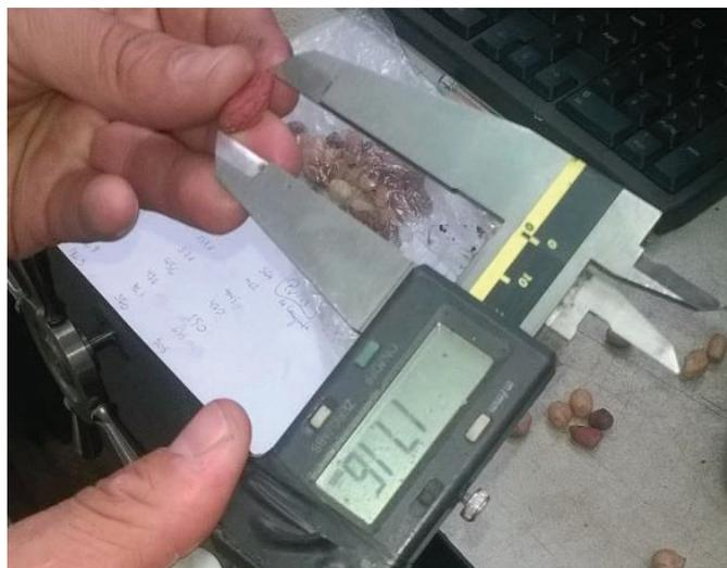
**Figura 2.5:** Medición de semillas de Maní.
