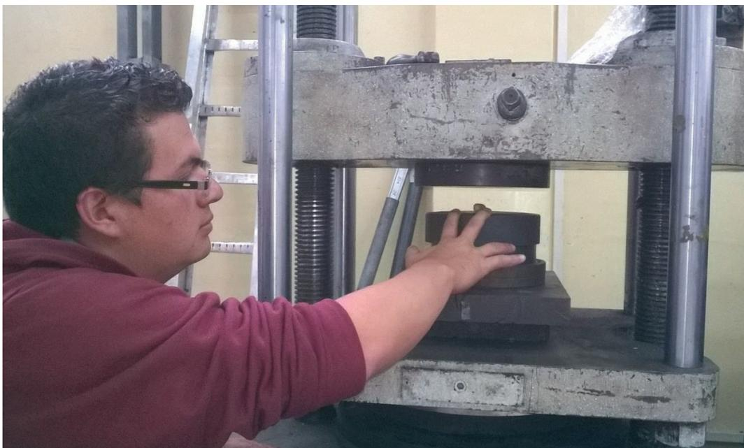
**Figura 2.7:** Ensayo de compresión (Muestra 2).
