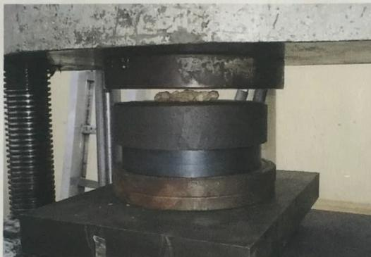
Fotografía 2. Montaje de las muestras de maní en la máquina universal de ensayos.
