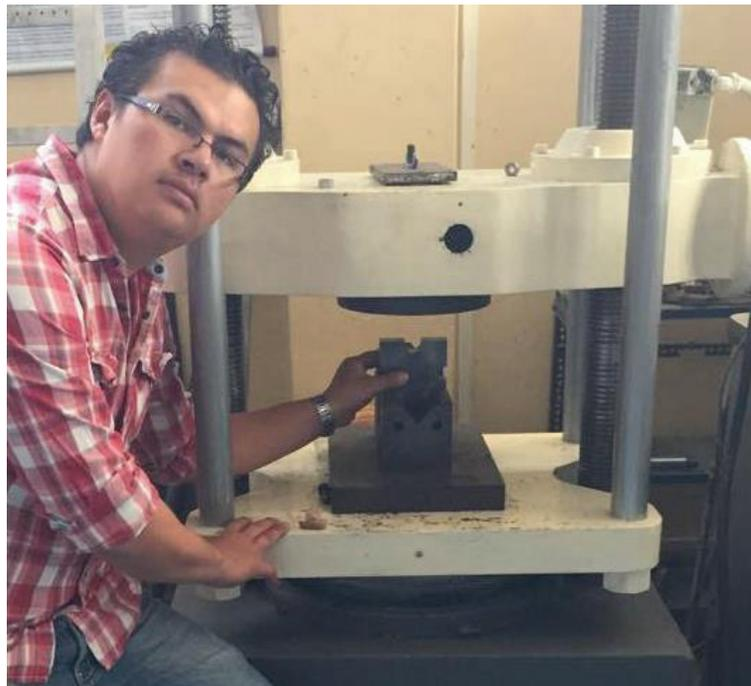
**Figura 2.11:** Máquina Universal de ensayos (Muestra 2).
