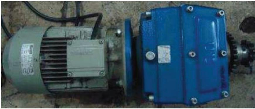
**Figura 3.10:** Motor reductor
