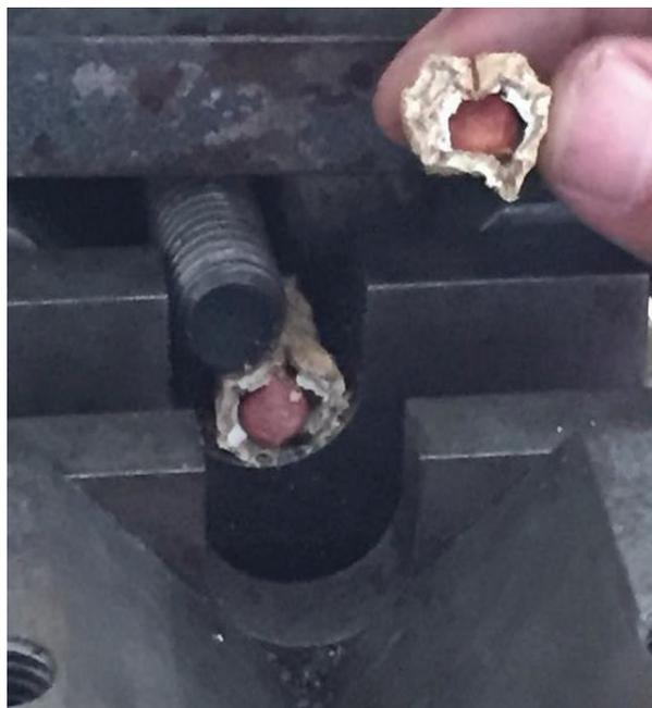
**Figura 2.13:** Corte de la vaina de maní después de la aplicación de la fuerza necesaria.
