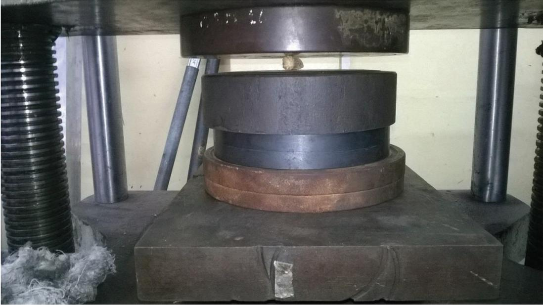
**Figura 2.8:** Ensayo de compresión a una vaina de Maní.
