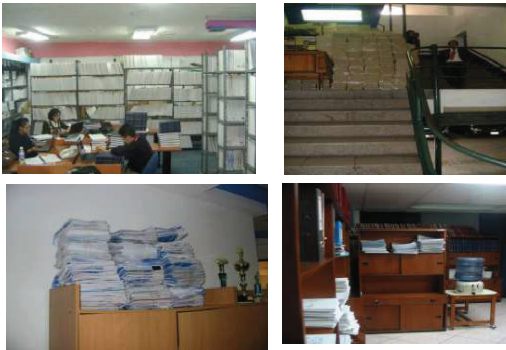
Figura 3.43. Alta carga combustible
