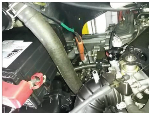
Figura 4.12 Conexión pinza trigger
