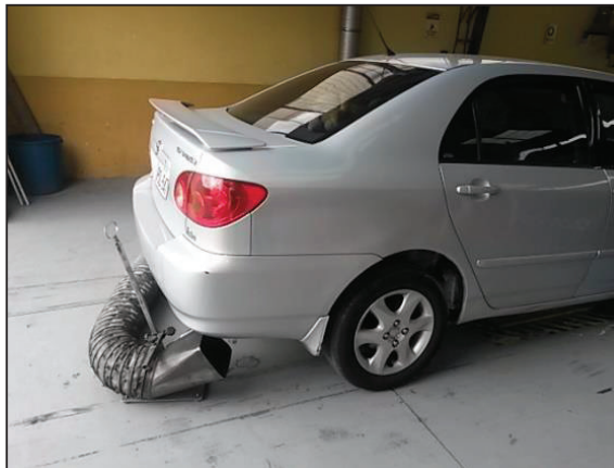
Figura 4.14 Instalación del ducto de gases
