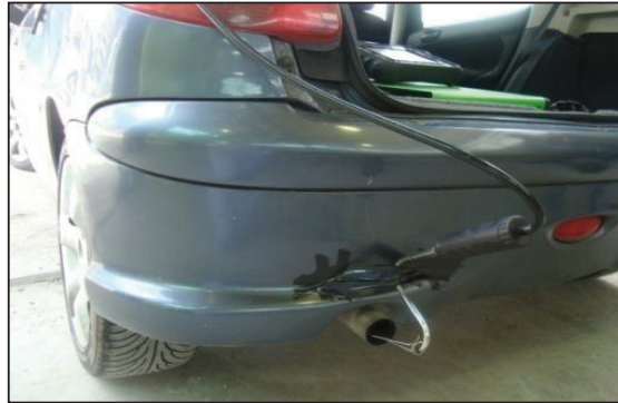
Figura 4.13 Conexión sonda analizador de gases
