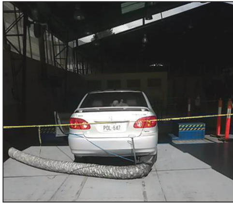
Figura 4.25 Instalación de sonda y ducto de gases
