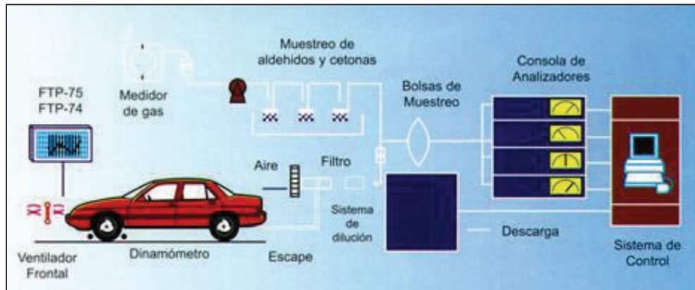
Figura 3.15 Procedimiento de prueba FTP75
