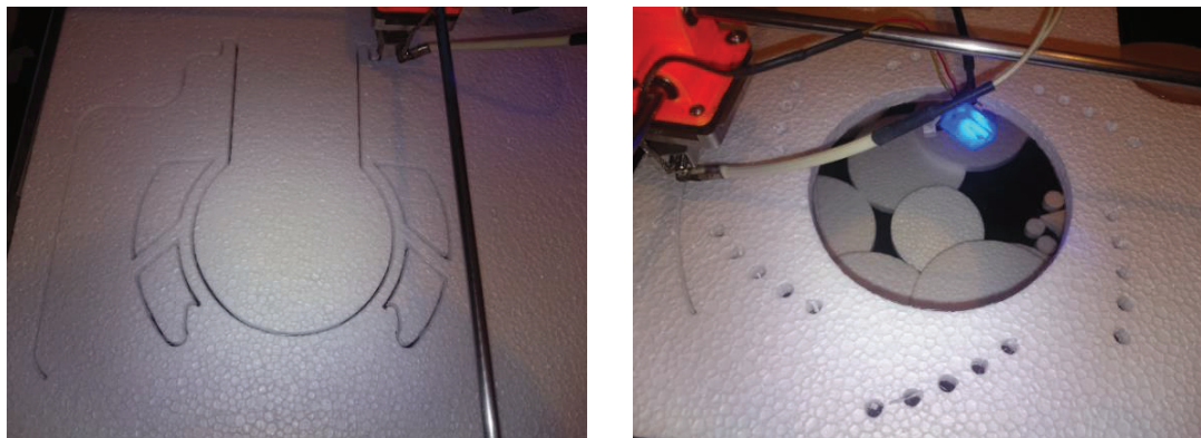
Figura 5.3 Fotografías del procedimiento de corte de las capas de los modelos 3D.
