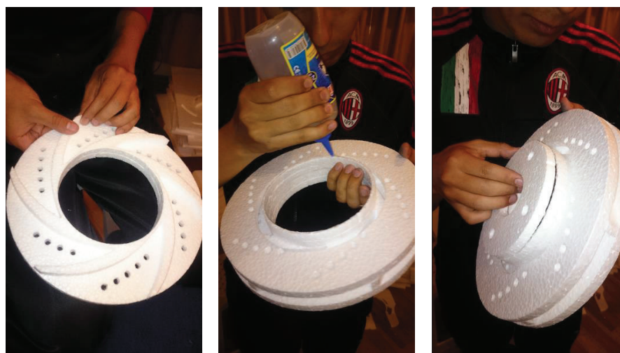
Figura 5.7 Fotografías del procedimiento de ensamble del modelo de EPS del disco de freno.
