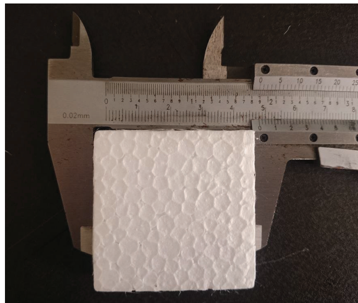
Figura 4.39 Medición de elemento cortado de 50x50mm
