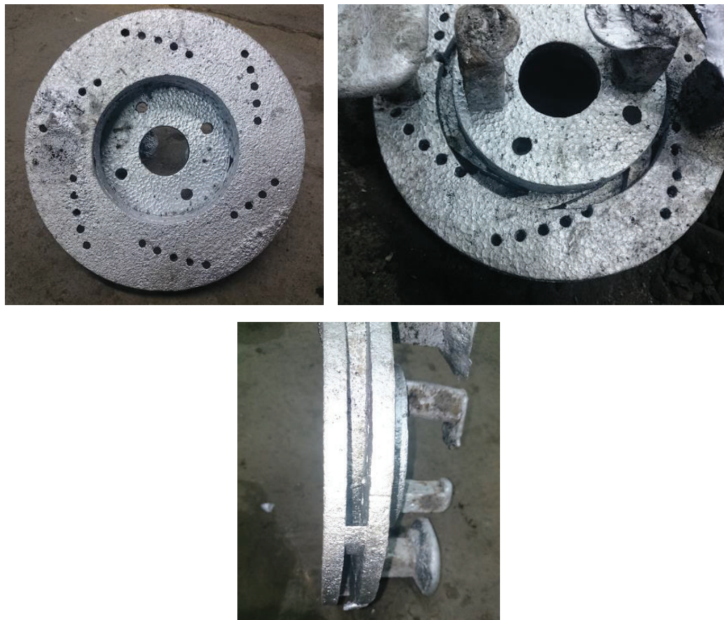
Figura 5.12 Fotografías del disco de freno fundido en aluminio.
