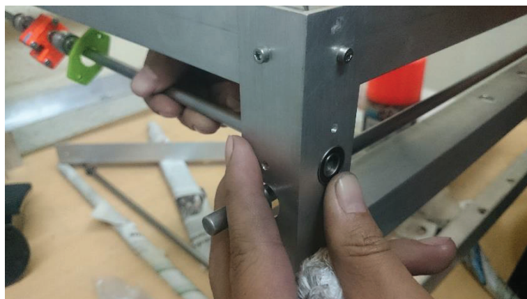
Figura C.0.2 Fotografías del procedimiento de montaje de los ejes conductores y conducidos.
