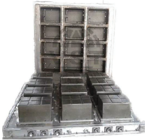
Figura 1.6 Molde para la obtención de cajas de EPS para frutas y vegetales 12 .
