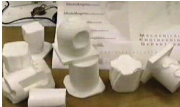
Figura 1.16 Piezas de espuma fabricadas con el sistema ModelAngelo 29 .
