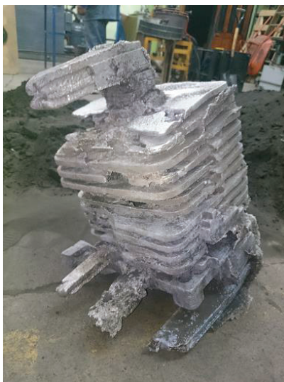
Figura 5.11 Fotografías del motor de un cilindro a escala fundido en aluminio.
