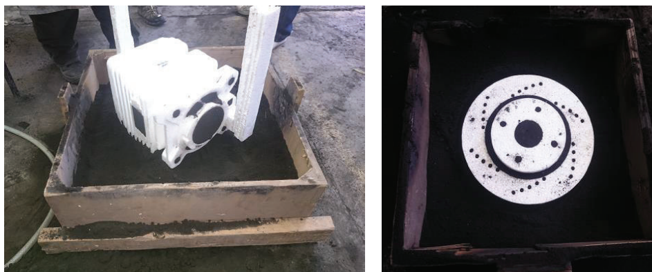
Figura 5.9 Fotografías del procedimiento de llenado de las cajas de moldeo.
