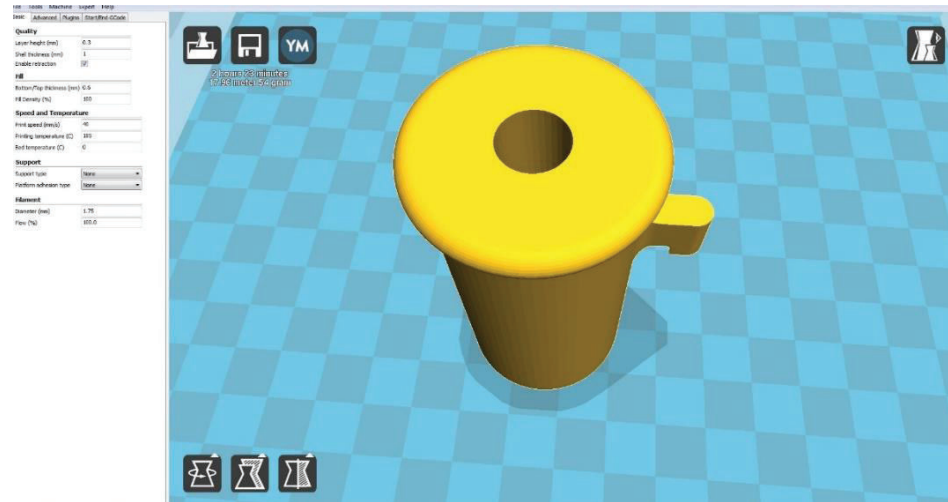
Figura 2.6 Interface del software de control Cura 52 .
