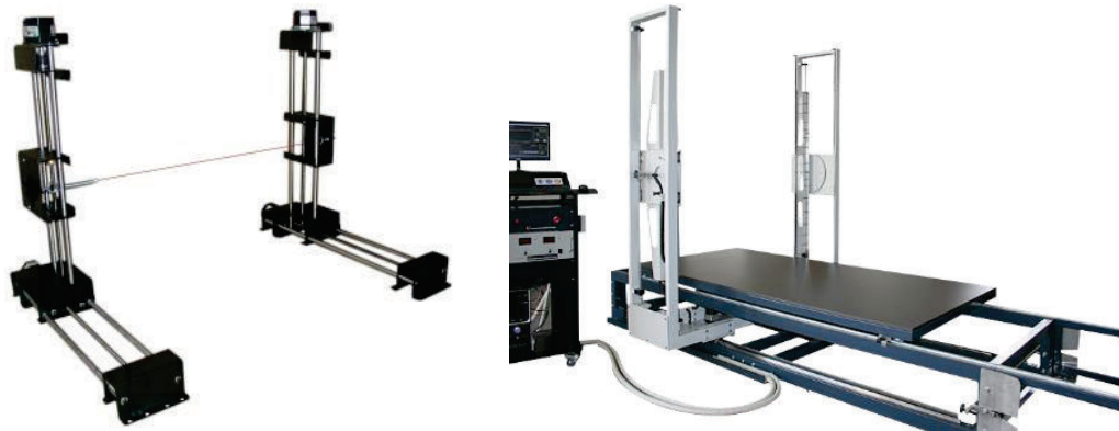
Figura 1.10 Máquinas CNC de “corte” por alambre caliente para EPS 23 .
