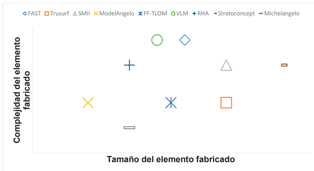
Figura 1.23 Comparación de capacidades de complejidad y tamaño de las máquinas de corte de espuma para PR 36 .
