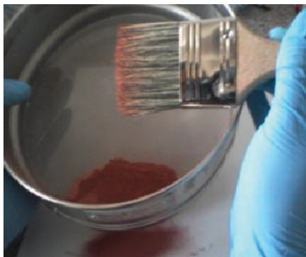
Figura 3.4: Muestra en polvo pasando por el tamiz de 45\ \mu\text{m} .
