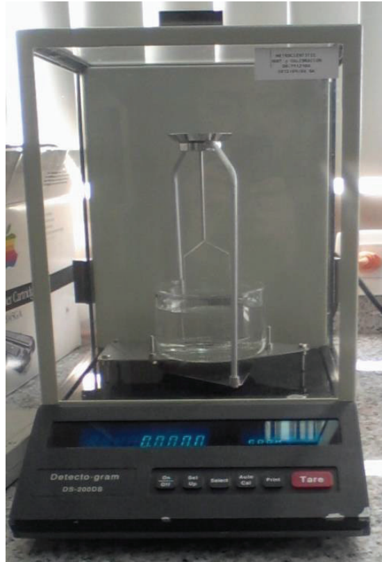
Figura 3.9: Balanza analítica y montaje para medir la densidad.
