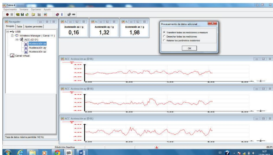
**Figura 3.16 Registro de datos del sensor de aceleración 3D.**
