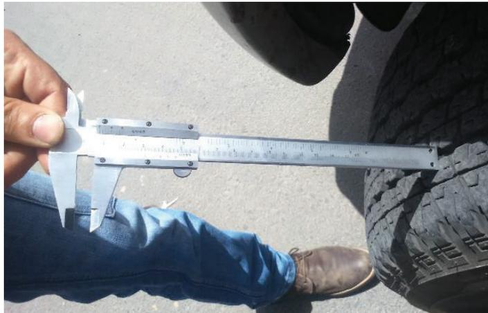
**Figura 3.2 Medición profundidad labrado de neumático.**
