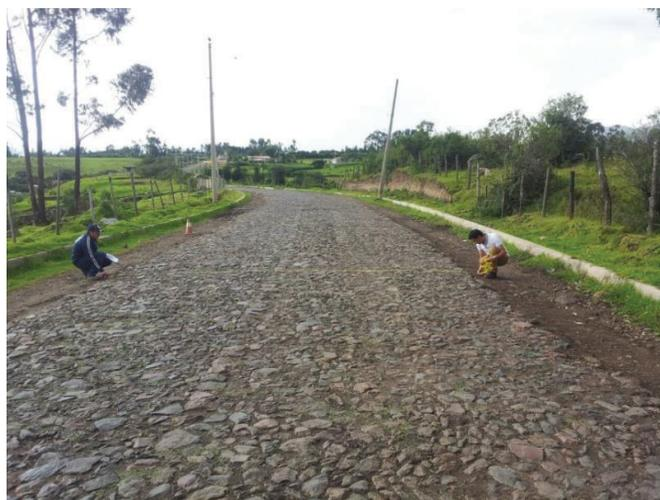
**Figura 3.12 Medición del ancho de la vía de pruebas con capa de rodadura empedrada.**
