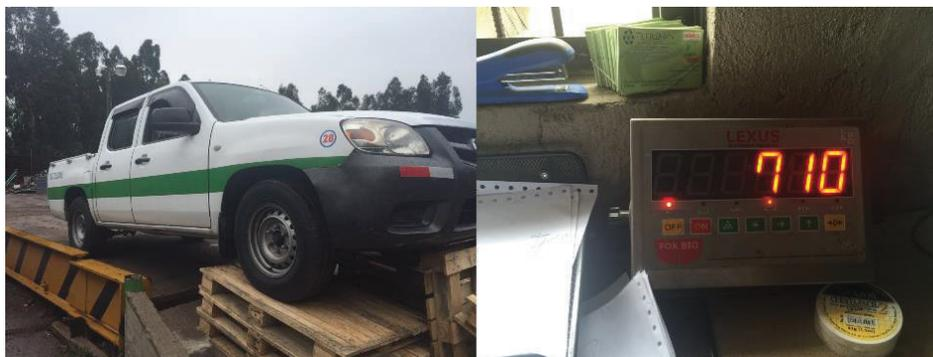
Figura 3.13 Pesaje del eje posterior del vehículo de pruebas.
