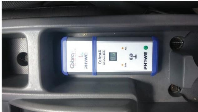
**Figura 3.15 Ubicación del sensor de aceleración en el vehículo.**
