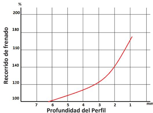
**Figura 1.3** Recorrido de frenado según el desgaste acanalado.
