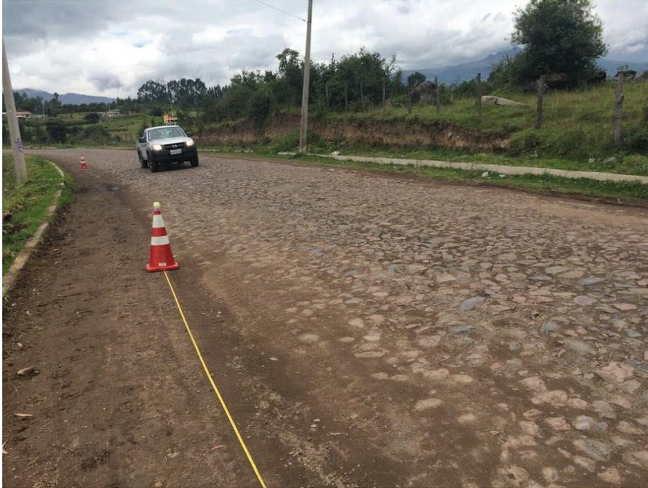
**Vehículo Mazda BT-50 Diésel 4x4 C.D. durante la prueba de frenado en superficie empedrada.**
