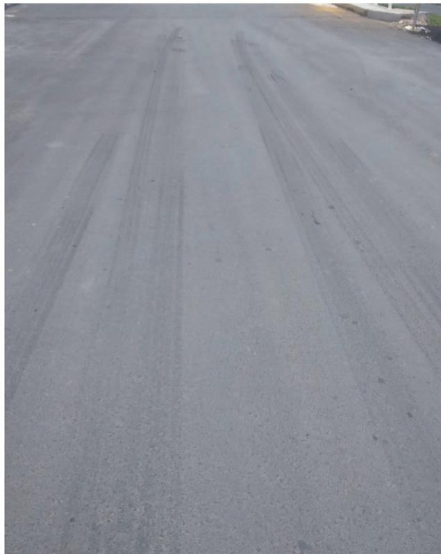
**Huellas de neumáticos en la vía después de las pruebas de frenado.**
