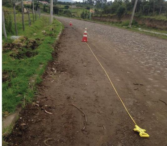
**Figura 2.3 Ubicación de señales sobre la calzada para medición de distancias de frenado.**
