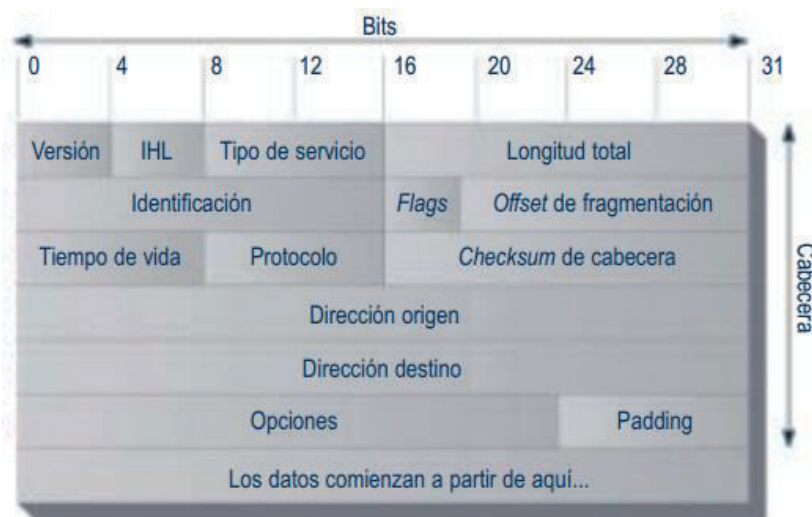
Figura 1.34 Datagrama del Protocolo IP. [39]
