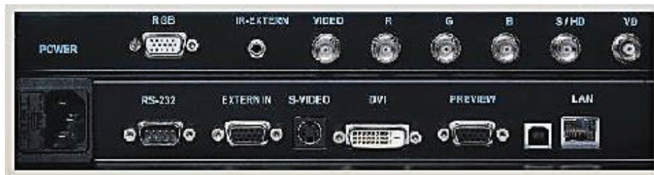
Figura 3.92 Puertos de la cámara de documentos. [122]
