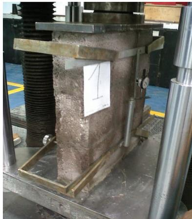
Cabe señalar que de los cuatro prismas, solamente los ensayos 1 y 4 se efectuaron con el marco instalado. Esto, con motivo de verificar que el marco metálico no tenga incidencia en la resistencia del murete. Es por esta razón que de los ensayos 2 y 3 se obtuvo resultados para resistencia a compresión pero no para módulo de elasticidad.
