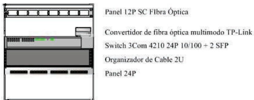
Figura 2.18 Rack abierto de pared 8U MDF40
