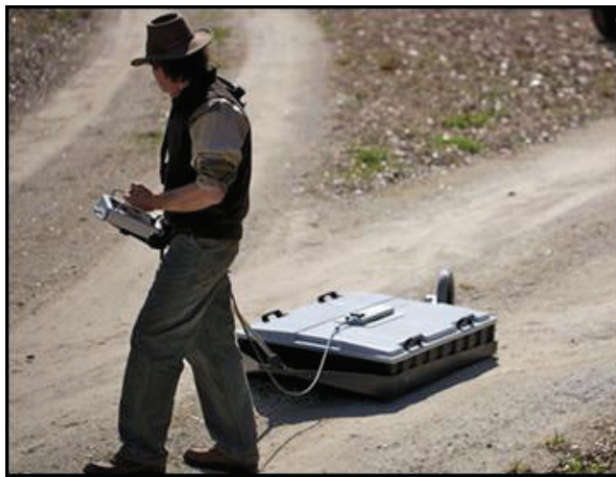
Figura 2.10 Radar XPro Mala con una antena blindada de 200Mhz empleada en investigación estratigráfica. (Mala Science. 2015).
