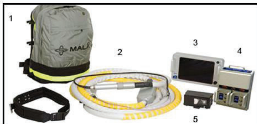
Figura 3.5 Componentes del GPR ProEx. 1) Mochila donde se guarda la Unidad de Control, 2) Antena no blindada, 3) Monitor, 4) Unidad de control , 5) Hilo para registrar distancia.
