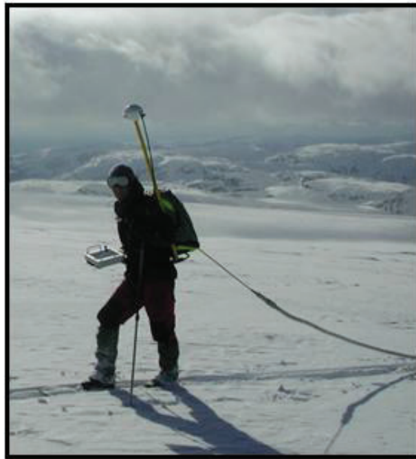
Figura 2.11 Radar ProEx Mala 25Mhz, utilizada en medición de espesor de glaciares. (Mala Science. 2015)
