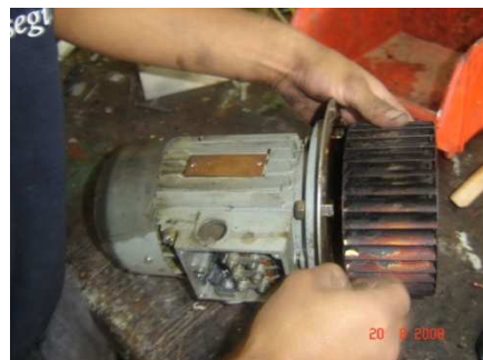
Figura A1.206 desmontaje rodete
