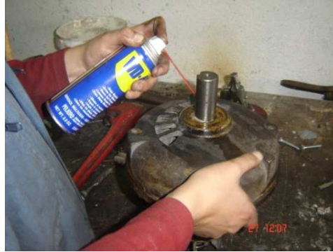
Figura A1.92 Limpieza con W40
