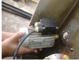
Figura A1.147 Desmontaje motor de la encofitadora
