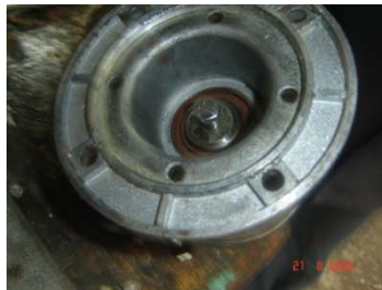
Figura A1.33 Desmontaje de motoreductor
