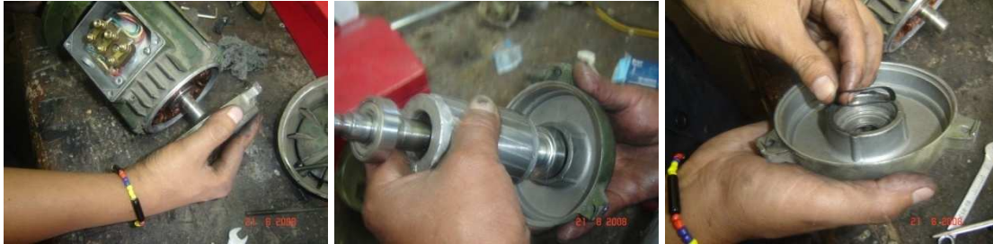
Figura A1.76 Desmontaje rotor y estator
