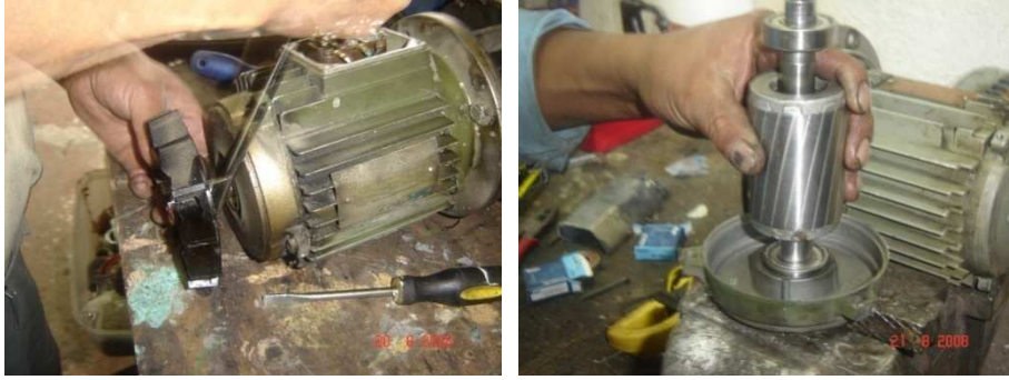
Figura A1.80 Desmontaje motor
