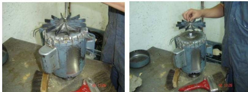
Figura A1.115a Desmontaje motor
