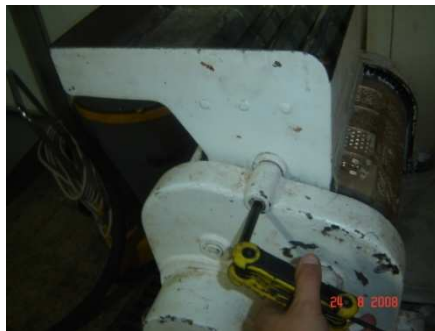
Figura A1.126 Desmontaje de tolva
