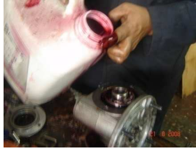
Figura A1.36 Líquido hidráulico
