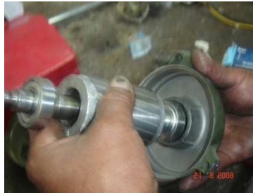
Figura A1.203 Desmontaje estator y rotor
