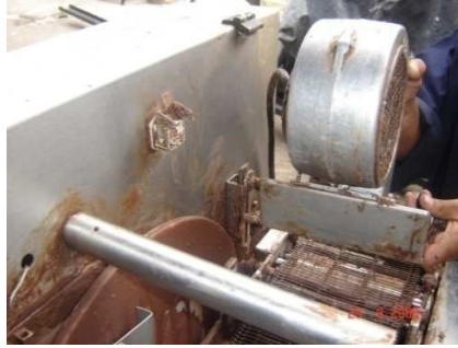
Figura A1.141 Desmontaje ventilador secado
