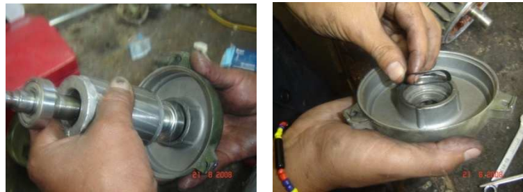
Figura A1.38 desmontaje rotor y estator
