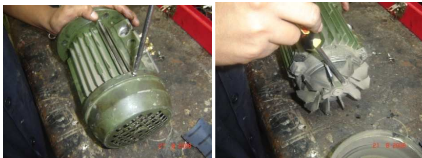
Figura A1.75 Desmontaje motor
