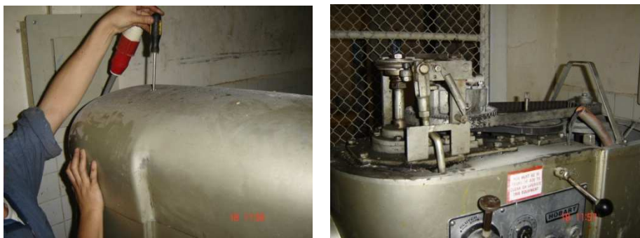
Figura A1.122 Desmontaje tapa superior
