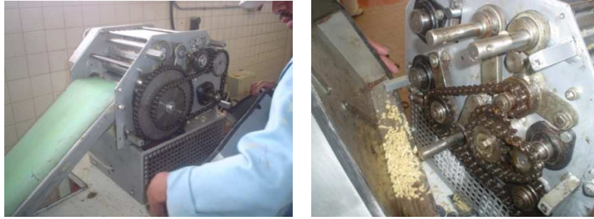
Figura A1.58 Sistema de transmisión de formadora.
