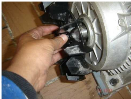
Figura A1.179 Desmontaje tapa y ventilador
