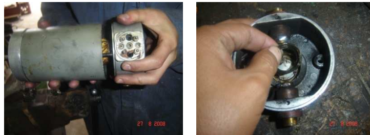
Figura A1.157 Desmontaje motor
