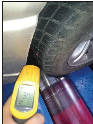
Figura 2. 9 Medición de la temperatura de la banda de rodadura.
