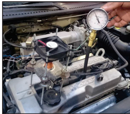
Figura 2. 14 Medición de presión con el manómetro y sensor.
