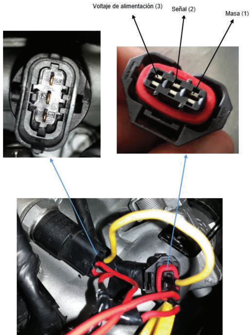
Figura 2.17. Conexión en el sensor RPS para el circuito de variación de presión de combustible en el riel. 68
