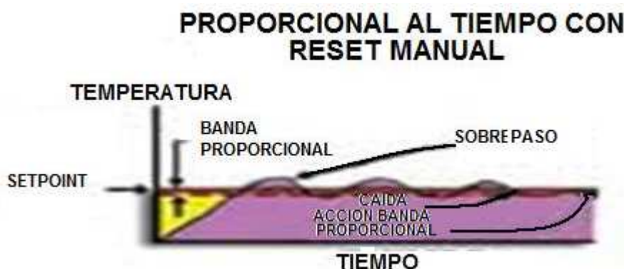
Fig. 1.33 Curva Temperatura Vs. Tiempo con Acción de Banda Proporcional
