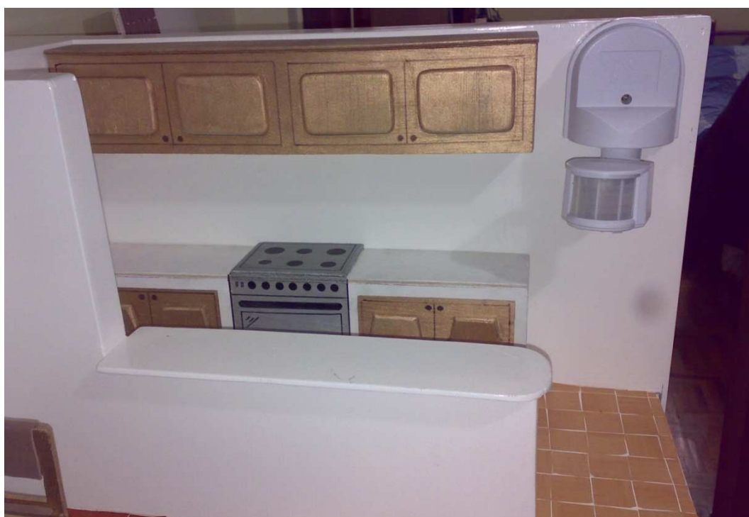
Fig. 2.6 Fotografía de la colocación del sensor de presencia.
