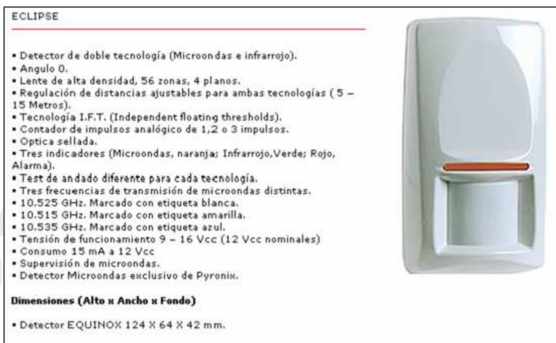
Fig. 1.51 Detector de presencia volumétrico para colocación de pared y sus características principales
