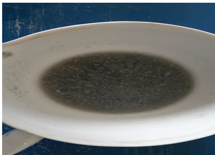
Figura 3.16. Lodos generados por el proceso de retrolavado en el filtro de arena y grava para un caudal de 5,5 L/min
