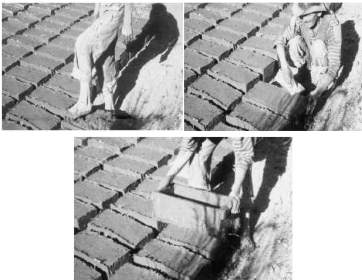
Figura 3-19 Proceso de elaboración de adobes en Ecuador.
