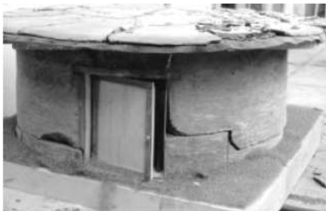
Figuras 3-6 a 3-10 Ensayos sísmicos para modelos con plantas cuadradas y circulares.
