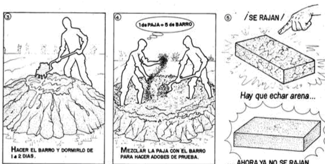
Figura 2-5 Control de microfisuración añadiendo paja
