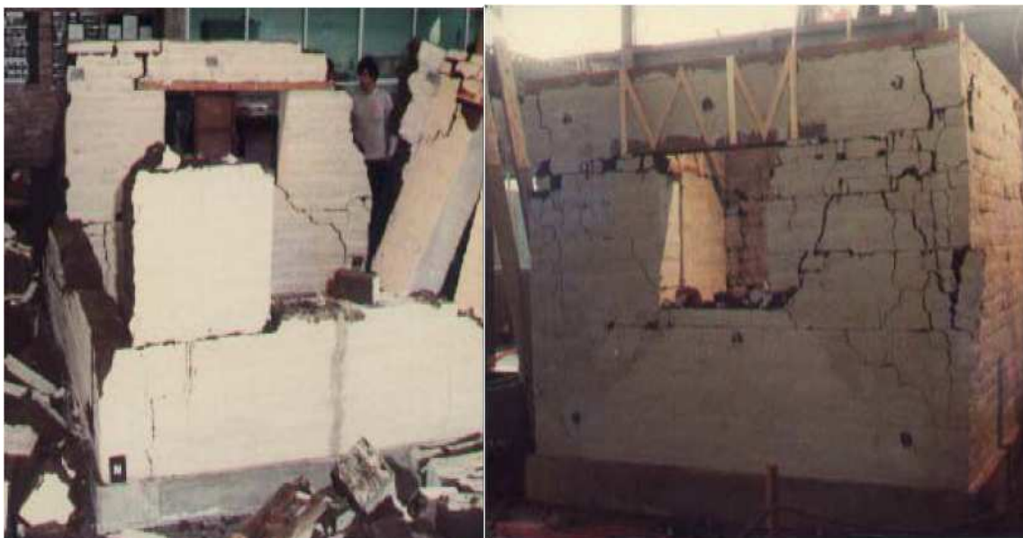
Figura 4-19 Comportamiento Sísmico de un Módulo de Adobe sin Refuerzo (Izquierda) y de un Módulo de Adobe con Refuerzo Interior de Caña y Viga Collar (Derecha)
