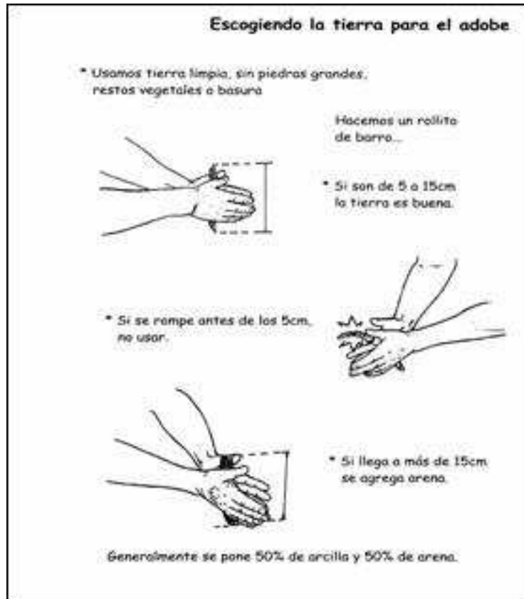
Figura 2-4 Ensayo del rollo
