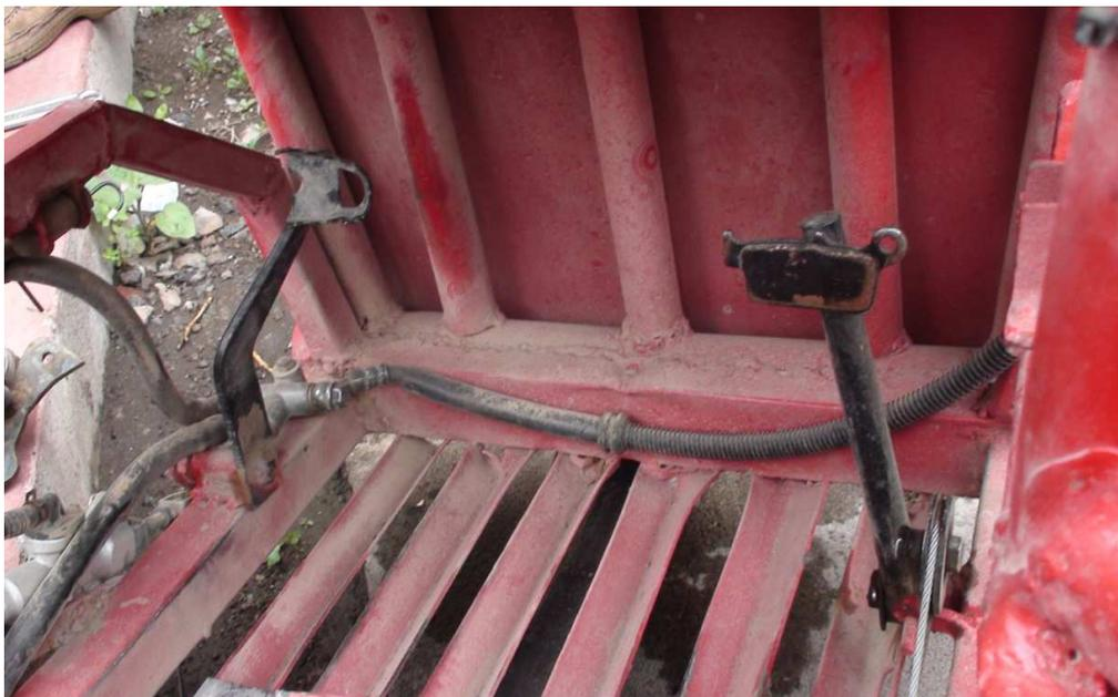
**Figura 4.8(b): Colocación de los pedales para el sistema de frenos.**
