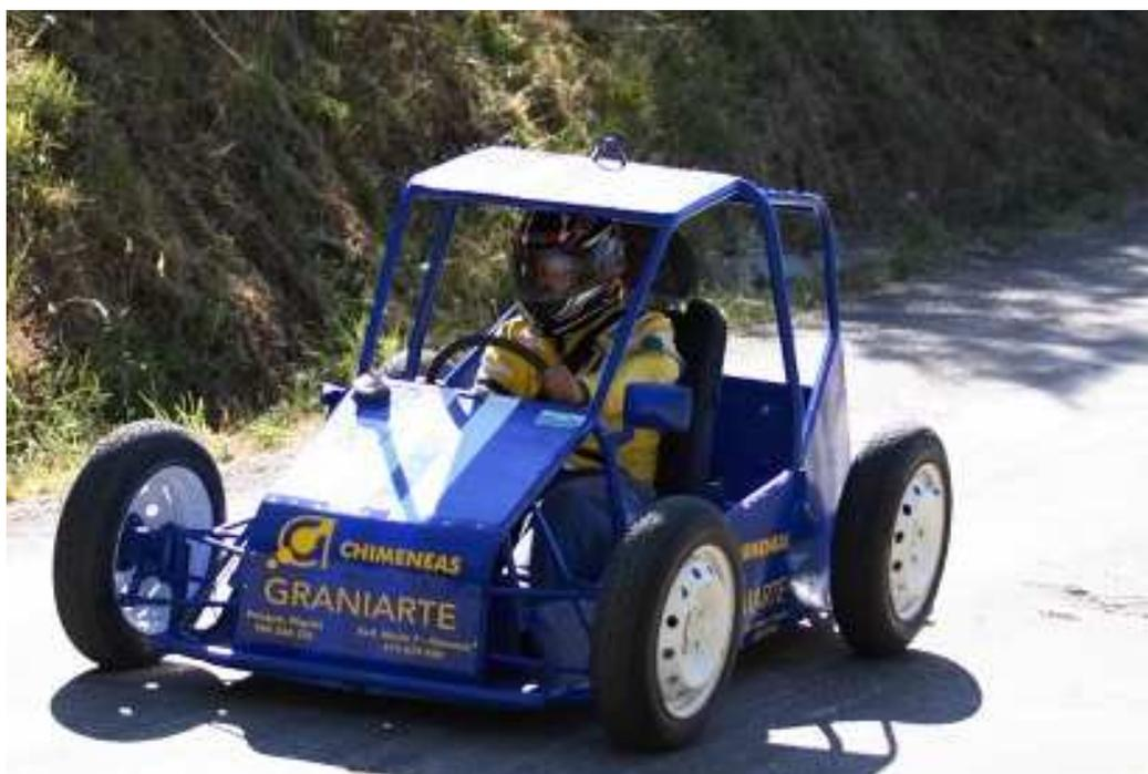
**Figura 2.12: Monoplaza con jaula de seguridad**
