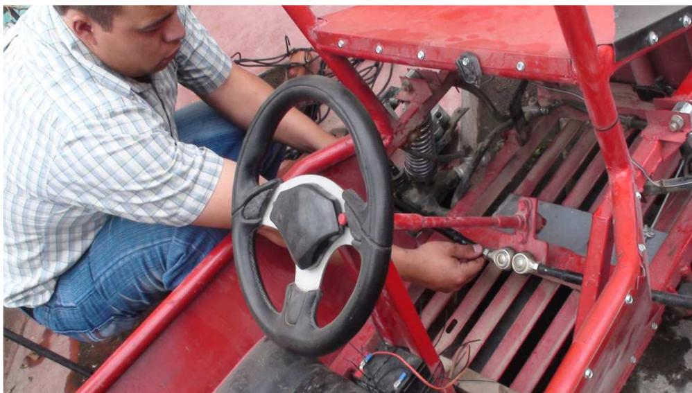
**Figura 4.9(b): Colocación de las barras para la dirección.**
