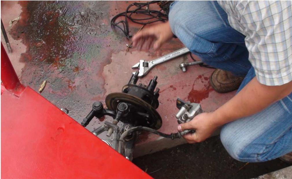
**Figura 4.7(a): Frenos de disco listo para su colocación**
