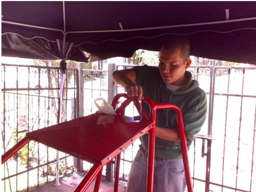
**Figura 4.10(b): Colocación del techo**
