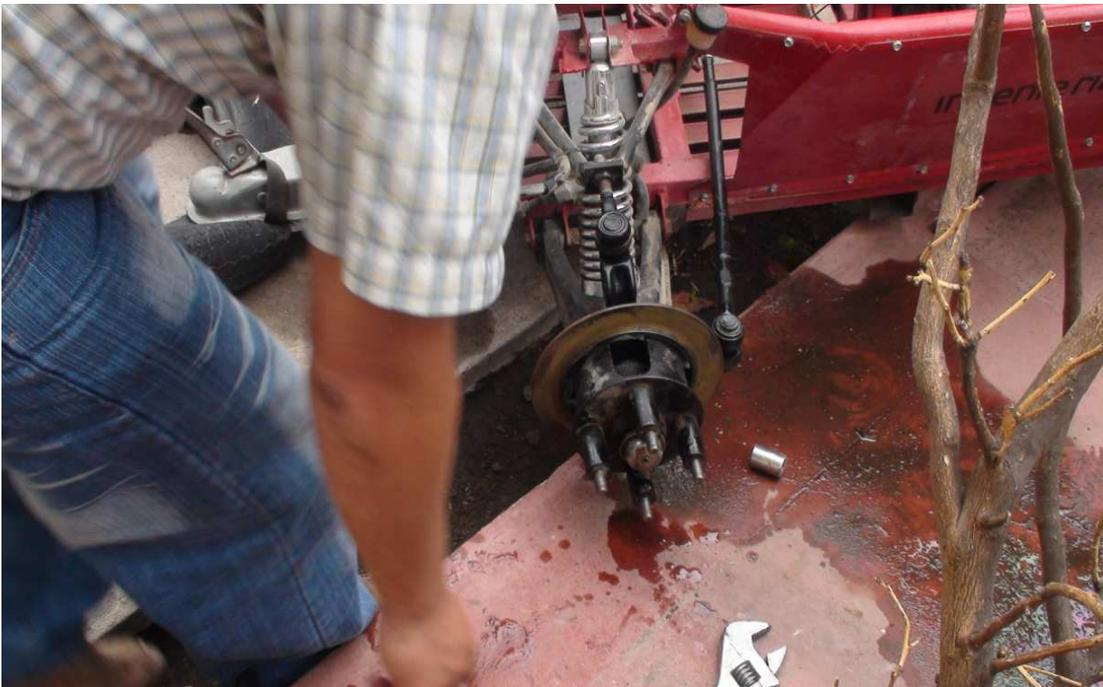
**Figura 4.6: Sistema de suspensión colocado en su totalidad.**
