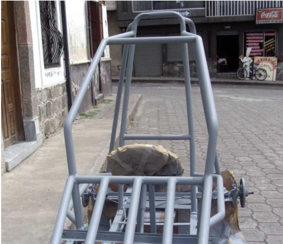
**Figura 4.3: Jaula de seguridad acoplada al bastidor**
