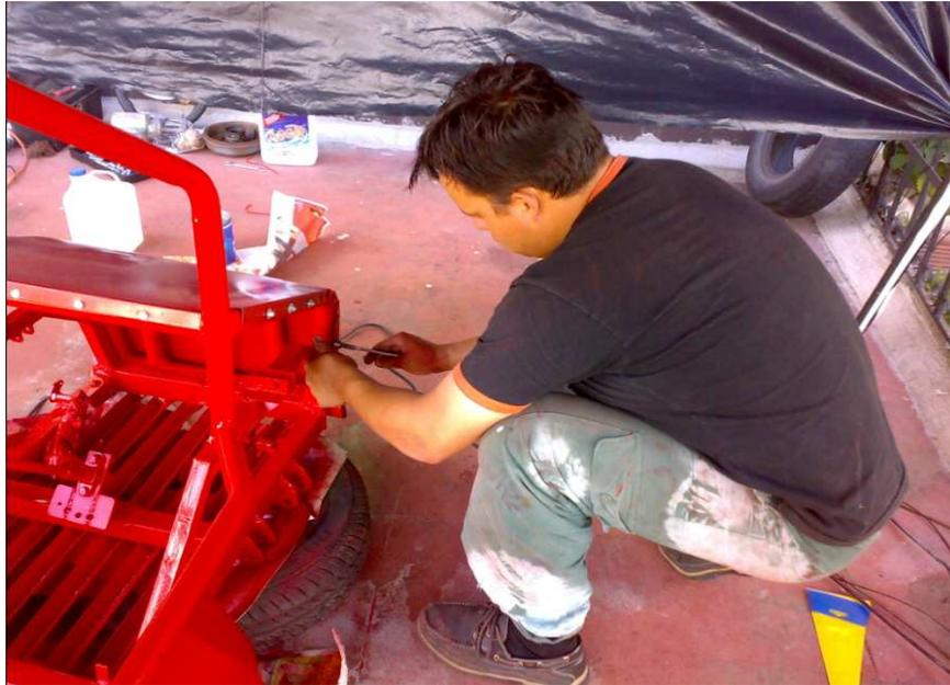
**Figura 4.10(c): Colocación de la plancha frontal**
