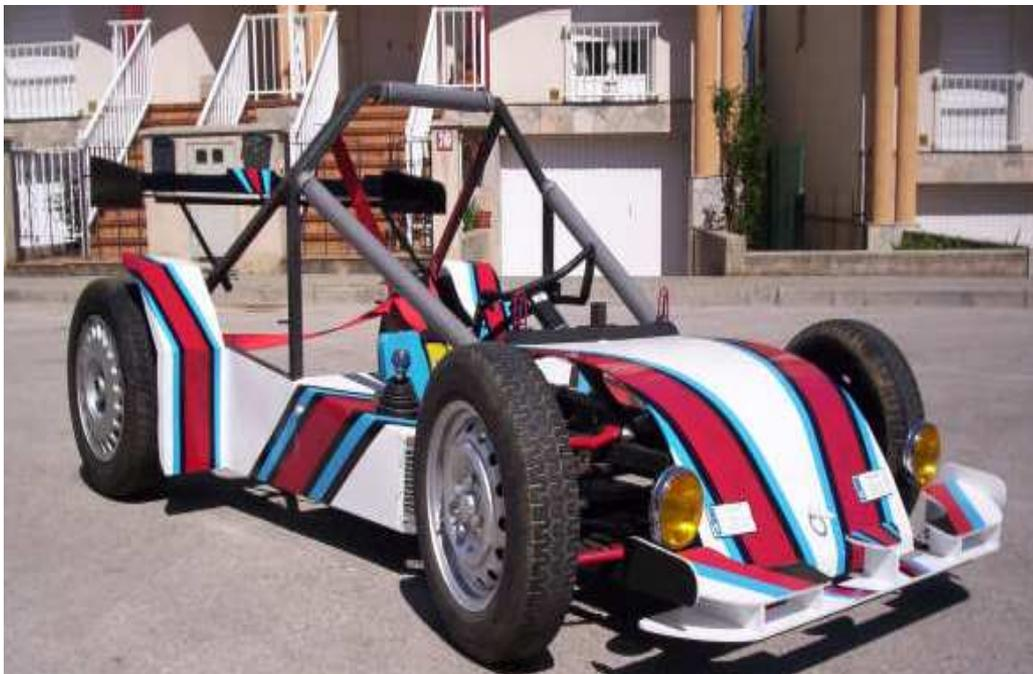
Figura 2.13: Monoplaza con barra antivuelcos
