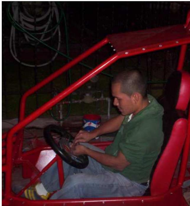
**Figura 4.11: Colocación del volante**
