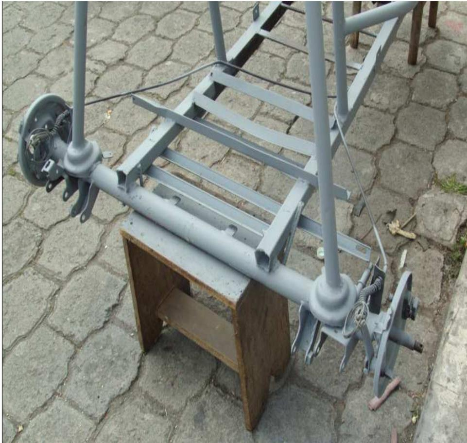
**Figura 4.2: Eje posterior ya colocado**
