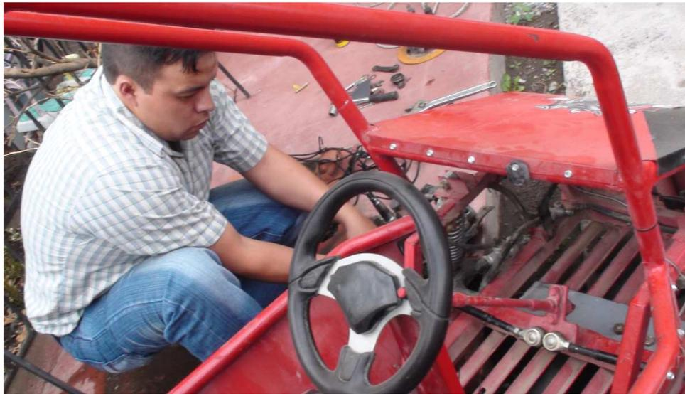
**Figura 4.9(a): Colocación de las barras para la dirección.**
