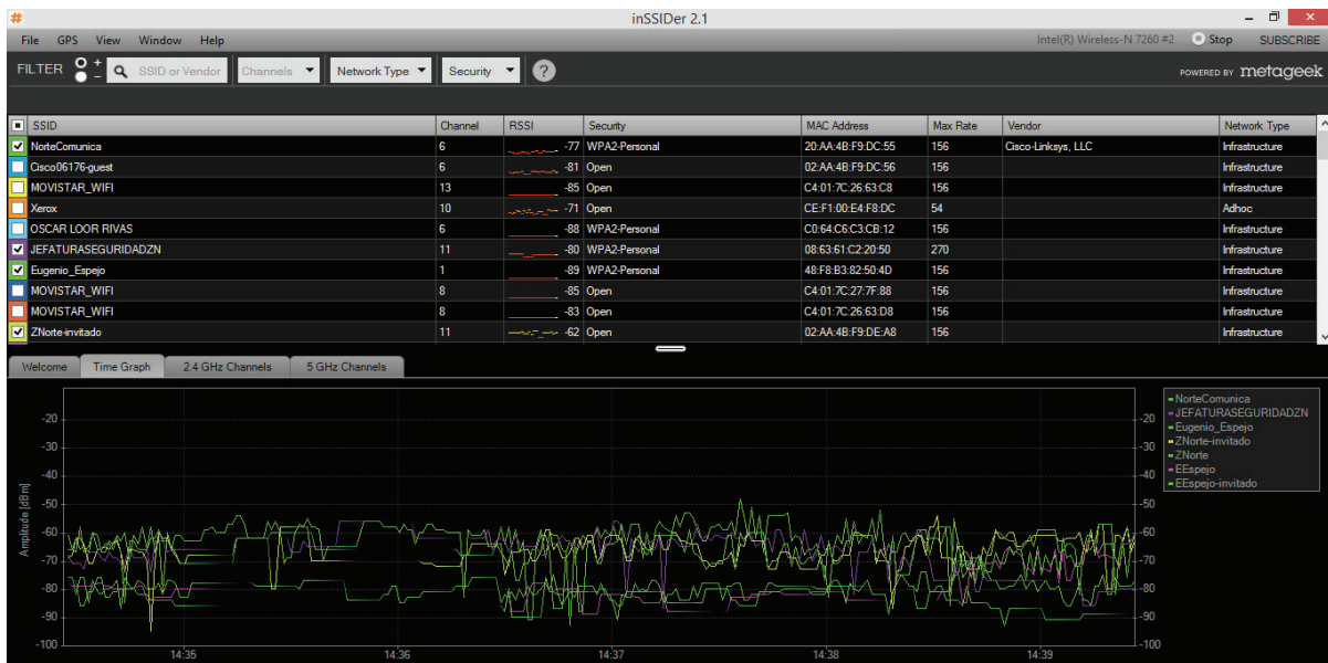
Figura 3.4 Intensidad de las señales desde el cuarto de telecomunicaciones
