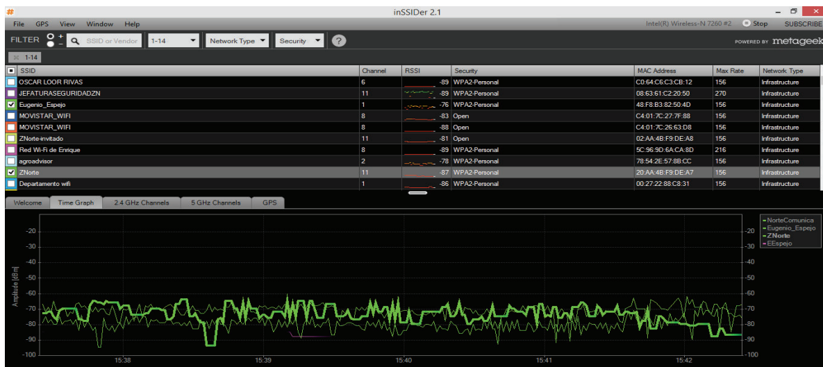
Figura 3.11 Señal del router inalámbrico Znorte desde Departamento de Proyectos.
