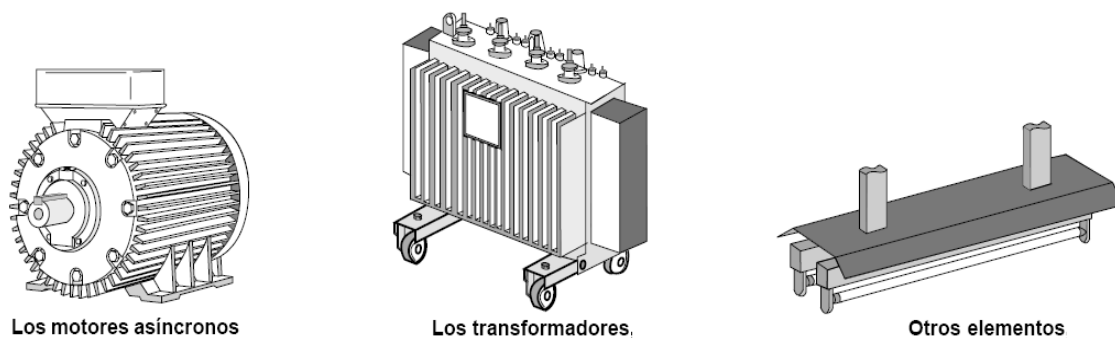
Figura 2.9 Receptores consumidores de energía reactiva.
