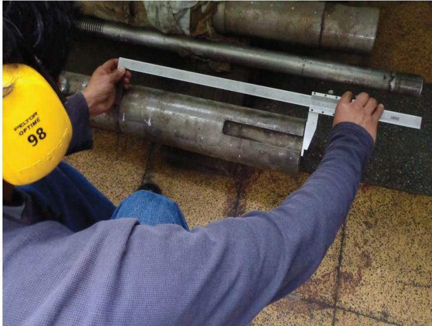
Figura 3. 12. Medidas del Eje (Fuente propia)
