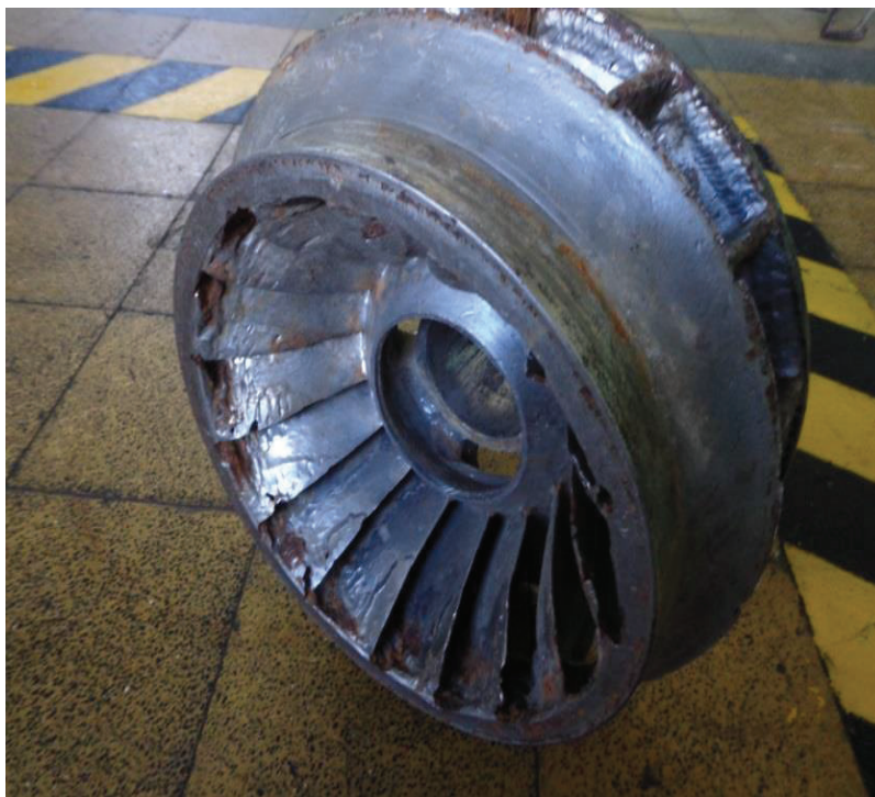
Figura 3. 1. Condición actual del rodete (Fuente propia)
