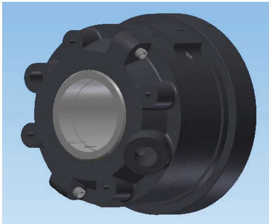
Figura 3. 26. Esquema del Laberinto (Fuente Propia)
