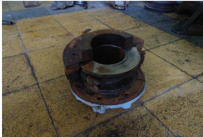
Figura 3. 6. Estado actual del Laberinto (Fuente propia)
