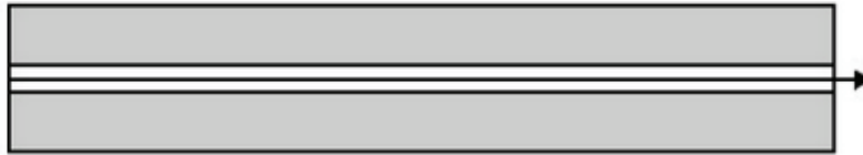
Figura 1.5 Figura monomodo de índice escalonado [5]
