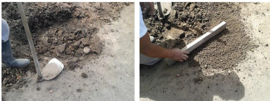
**Figura E. 1** a) Extracción de la tierra, b) Reducción del tamaño de grano
