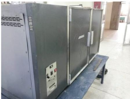
**Figura B. 2** Horno eléctrico para secado GCA Precision Scientific
