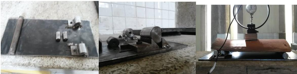
**Figura B. 10** Soporte de acero para alineación de la teja.
