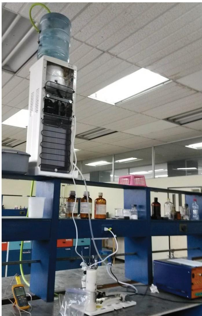
**Figura B. 15** Dispensador TCL conectado al equipo Armfield HT10x
