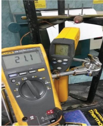
**Figura 3.24** Probeta de adobe y termómetros para determinar  $T_{\infty}$  y  $T_s$ .
