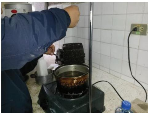
**Figura 3.4** Proceso de cubrir con parafina a las probetas
