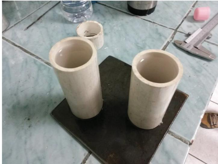
**Figura D. 2** Moldes de tubo PVC
