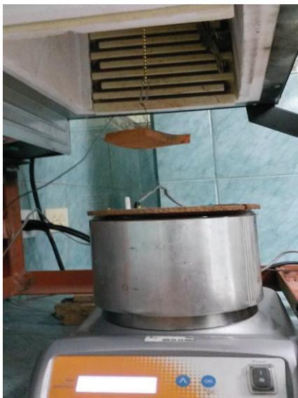
**Figura 3.21** Recipiente Dewar sobre agitador magnético y probeta de teja.
