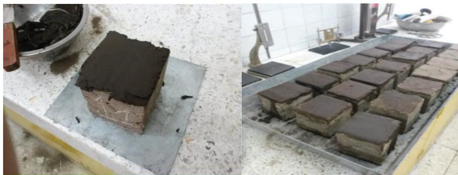
**Figura 3.6** Capa de tierra para conseguir superficies planas y paralelas
