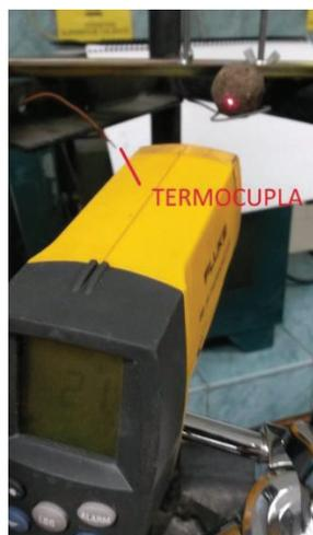
**Figura 3.25** Probeta de adobe y termocupla para determinar  $T_{\infty}$
