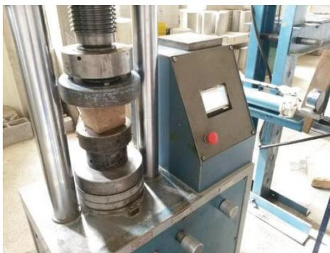
**Figura 3.7** Probeta de adobe en la máquina de ensayos
