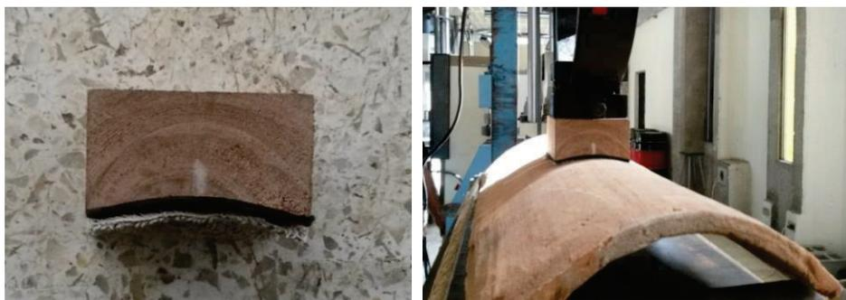
**Figura 3.8** Acoplamiento de madera para aplicación de carga
