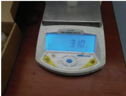
**Figura B. 4** Balanza electrónica Adam PGL 6001
