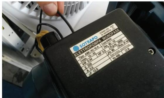
**Figura B. 16** Placa de electrobomba Sotrapo
