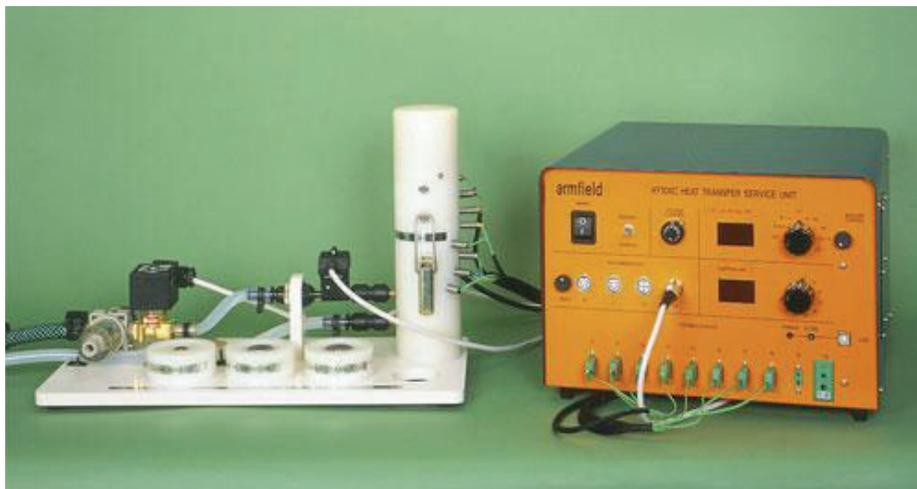
**Figura B. 13** Equipo de conducción lineal Armfield HT10X
