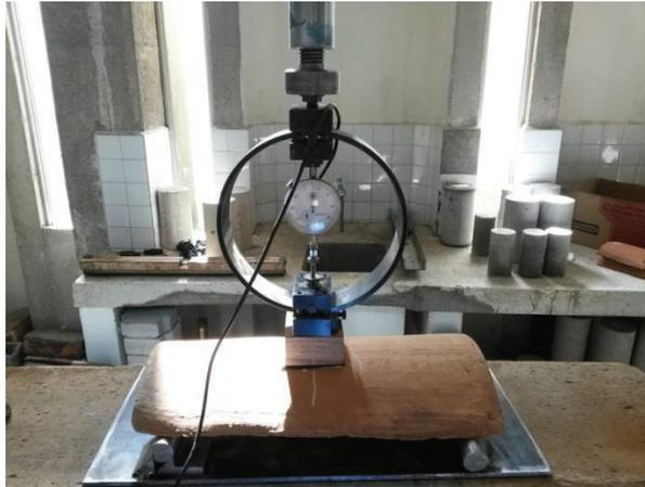
**Figura B. 11** Prensa de ensayos a flexión
