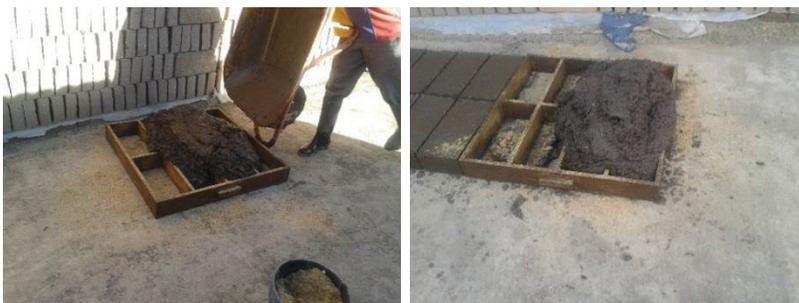
**Figura E. 13** Poner la mezcla en el molde
