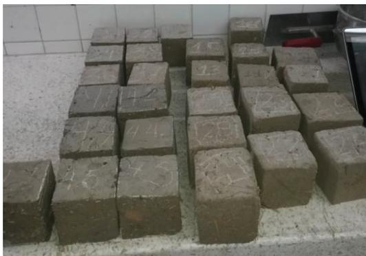
**Figura 3.3** Probetas de adobe para ensayos de densidad
