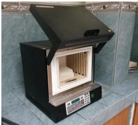
**Figura B. 18** Horno Vulcan para ensayo de calor específico
