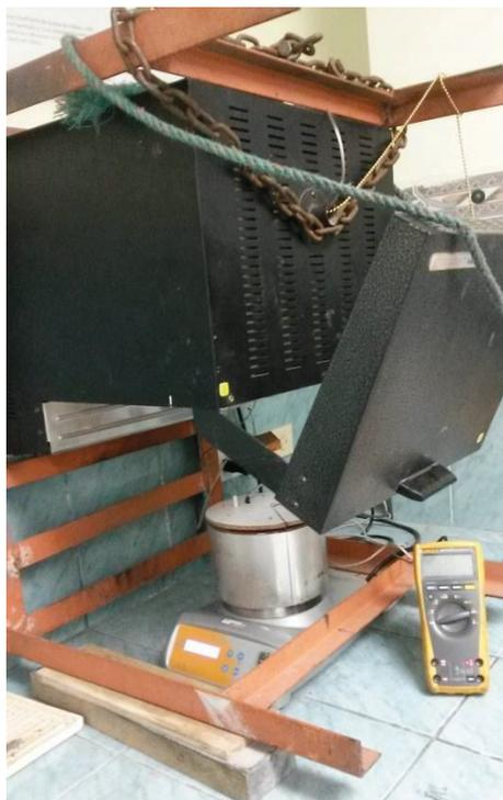
**Figura 3.20** Horno Vulcan para ensayo de calor específico
