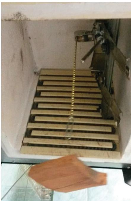
**Figura 3.22** Probeta de teja en el interior del horno y termocupla tipo K.
