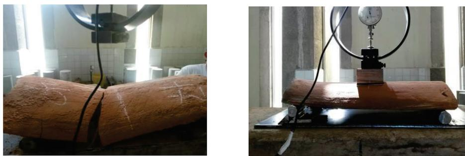
**Figura 3.9** Ensayo de flexión a la teja artesanal
