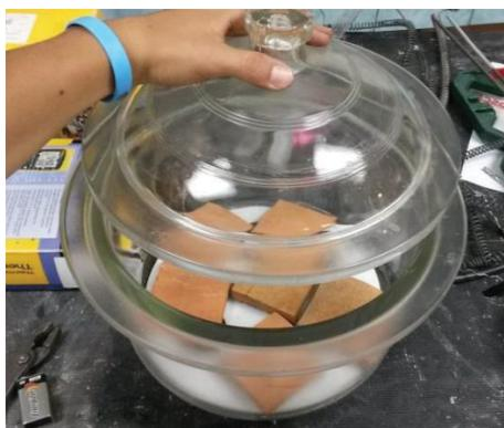
**Figura 3.19** Probetas de teja dentro del desecador
