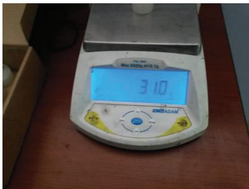
**Figura D. 4** Balanza Adam para la determinación de masa de las probetas
