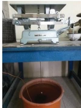
**Figura B. 5** Balanza hidrostática analógica Murayama Seisakusho Ltd.
