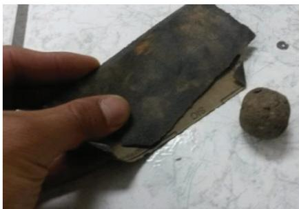
**Figura 3.23** Proceso de obtención de probetas esféricas mediante lijas
