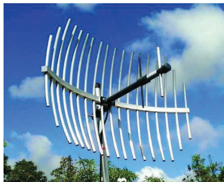
FOTOGRAFÍA 2.6. Antenas de rejilla
