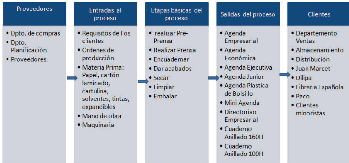
Figura 32 –Diagrama SIPOC – nivel macro del proceso de producción Fuente: Empresa Gama Editores
