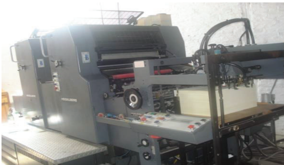
Figura 3–M.O.Bicolor. Prensa Offset, imprime 9000 pliegos por hora, dos colores a la vez
