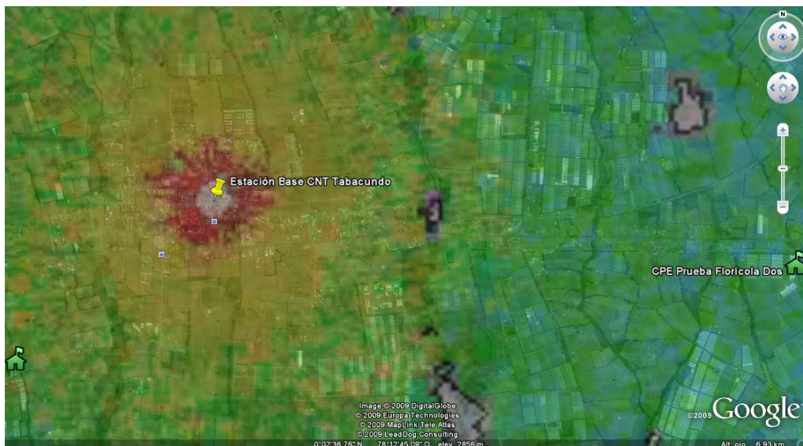
Figura No. 3.34 Cobertura Radio Base Dos fusionada con imagen satelital
