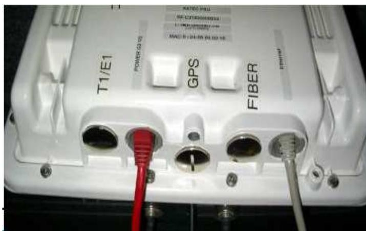
**Fig. 1.20** Interfaces de los equipos con modulación OFDM
