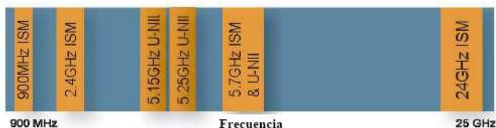
**Fig. 1.16** Bandas de frecuencia no licenciada
