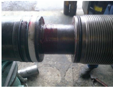
Fotografía 3.1 Cámara entre el Pistón y el Conector
