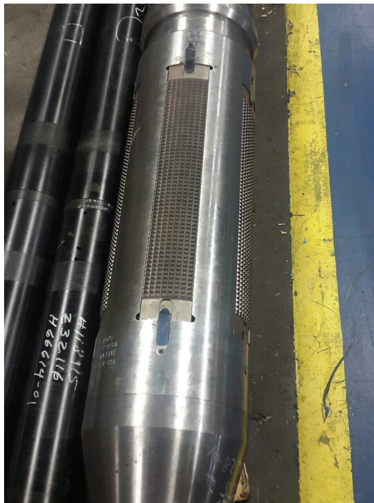
Fotografía Sección de Anclaje
