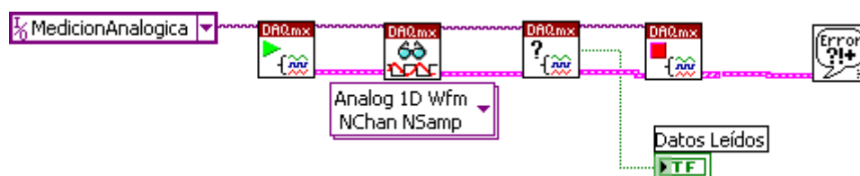
Figura 3.13. Implementación de adquisición de datos.
