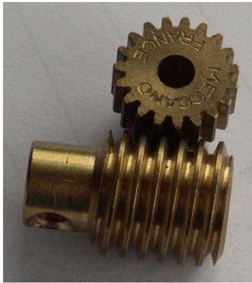
Figura 1.4.- Engranaje de gusano
