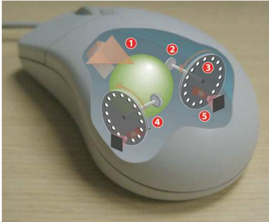
Figura 1.6.- Nótese las ruedas ópticas en este modelo de Mouse antiguo
