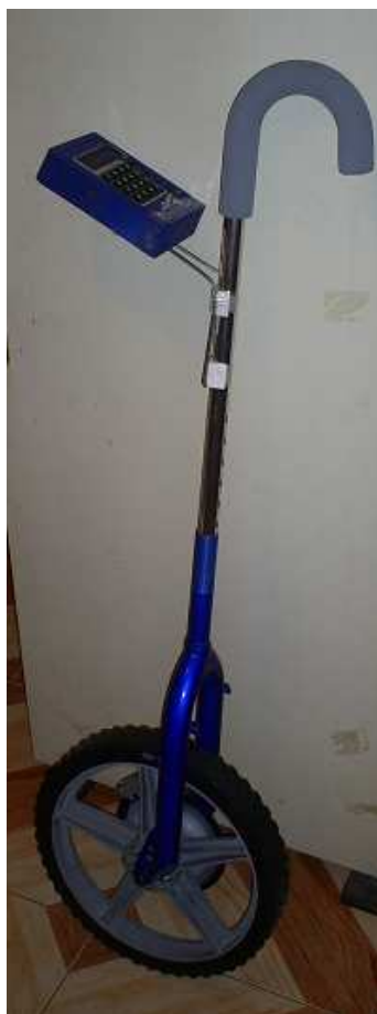
Figura 2.18.- Odómetro Digital Terminado.
