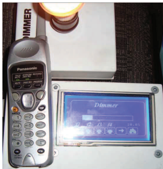
Figura 4-5.- Prueba de interferencia con el teléfono inalámbrico
