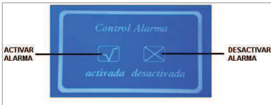
Figura 3-21.- Pantalla de control de activación de alarma
