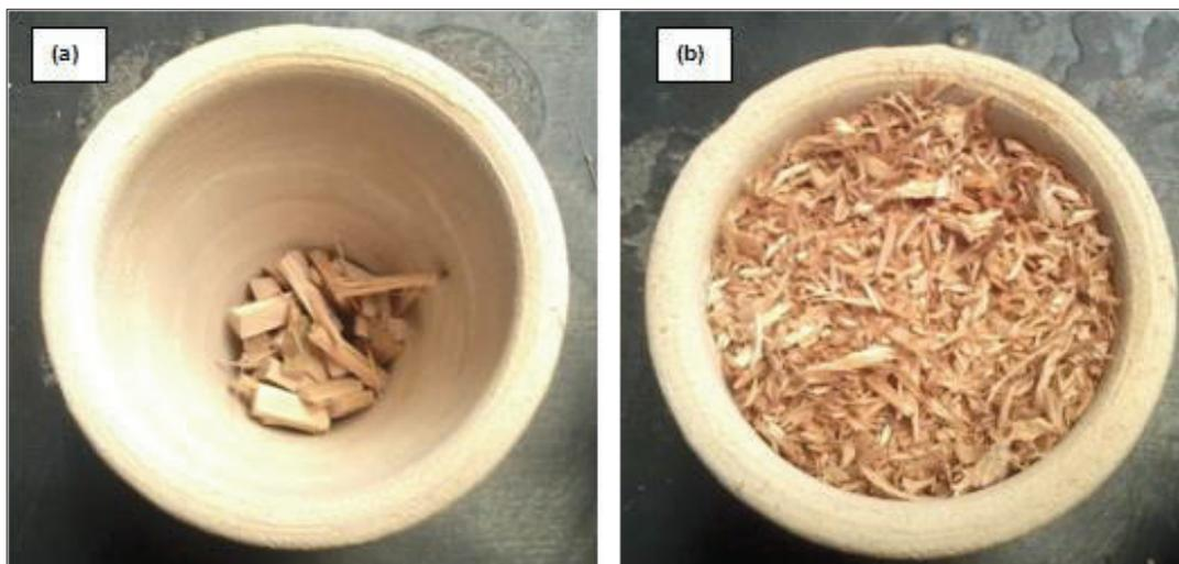
**Figura 2.1.** Esquemas de los crisoles con (a) muestra de caña guadua y (b) tapada con aserrín para la carbonización de la caña guadua
