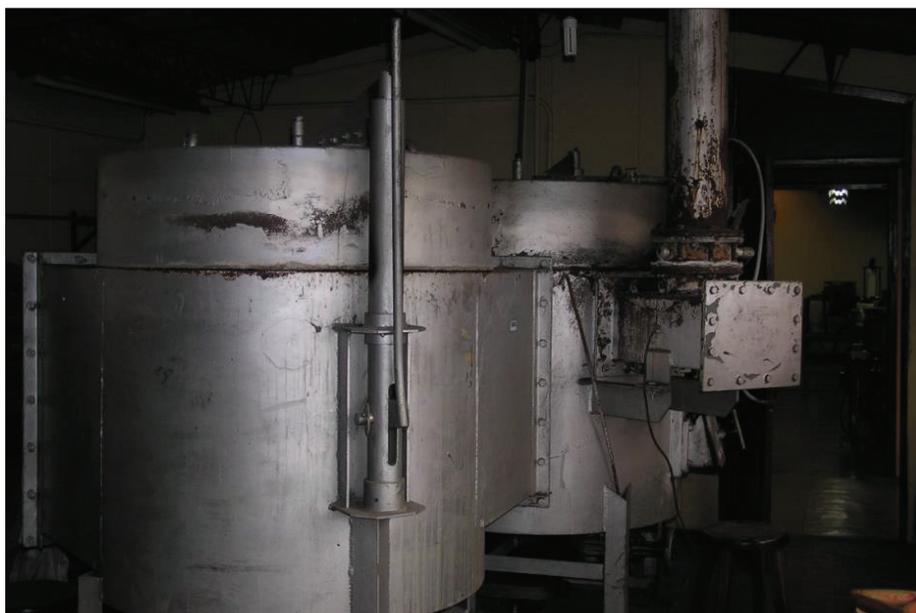
**Figura 2.2.** Horno piloto Nichols Herreshoff mono solera
