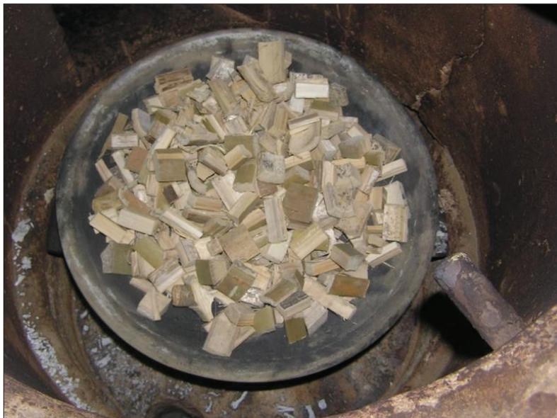
**Figura 2.3.** Caña guadua troceada al interior del horno piloto mono solera Nichols Herreshoff con el sistema sin agitación
