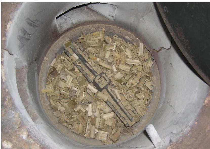
**Figura 2.4.** Caña guadua troceada al interior del horno piloto mono solera Nichols Herreshoff con el sistema de agitación
