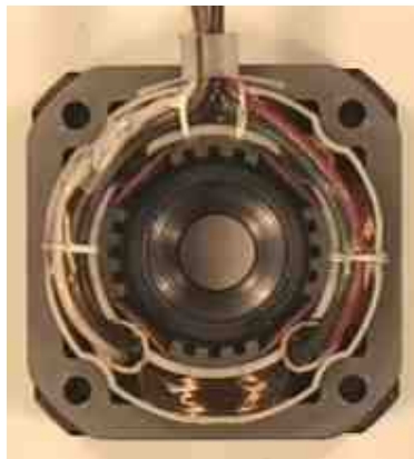
FIGURA 1.4 (Estator de 4 bobinas de un motor PaP)
