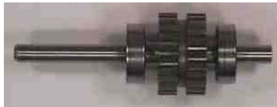
FIGURA 1.3 (El rotor del motor PaP)
