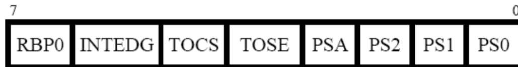
FIGURA 1.14 (Estructura del Registro Option)
