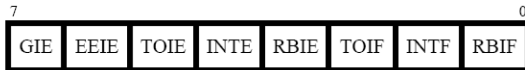
FIGURA 1.15 (Estructura del Registro INTCON)
