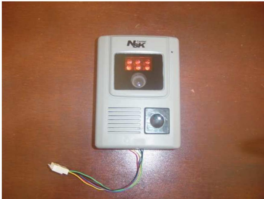
*Figura 2.3. Módulo externo Modelo NSK 7157*
