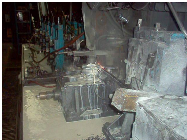
FOTOGRAFIA N° 23 Proceso continuo de soldadura por inducción.
