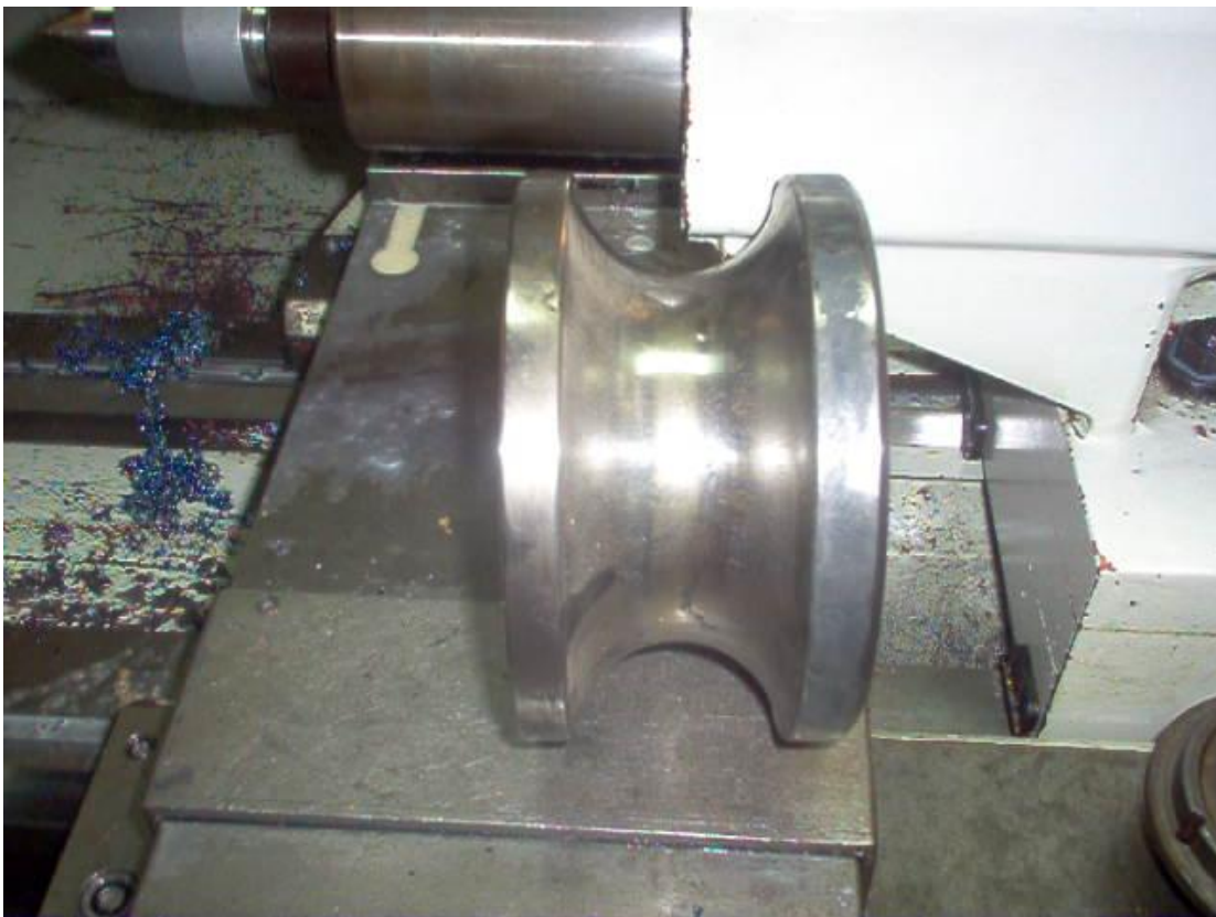
FOTOGRAFIA N° 10 Rodillos SQ desgastado.
