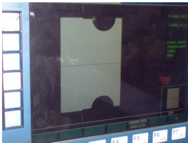
FOTOGRAFIA N° 14 Herramienta en la posición final del perfil del rodillo.
