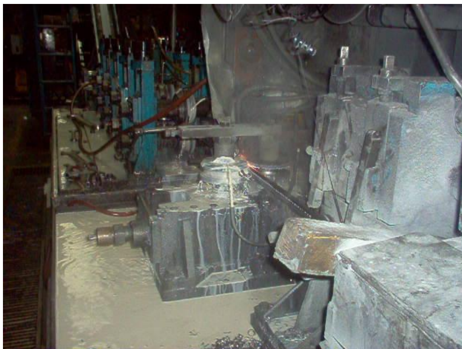
FOTOGRAFIA N° 6 Rodillos SQ en el proceso de soldadura.
