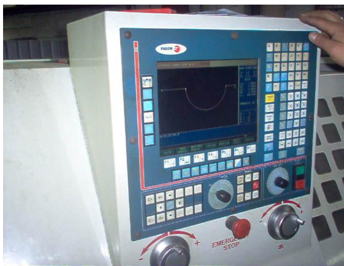
FOTOGRAFIA N° 11 Perfil del rodillo a rectificar.
