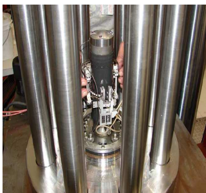
Figura 2.23 Instrumentación instalada en la muestra.
