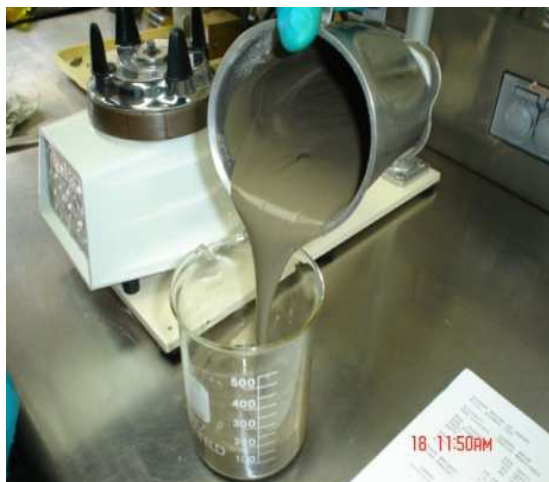
Figura 2.16 Elaboración de la lechada de cemento
