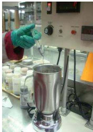
Figura A2.6 Colocación de aditivos en el mixer
