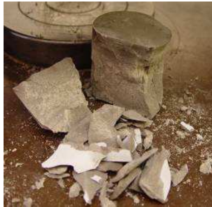
Figura 2.21 Ensayo de compresión sin confinamiento después de la destrucción para una lechada convencional
