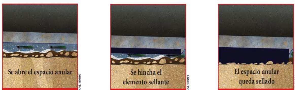
Figura 2.37 Descripción de funcionamiento del Cement Assurance Tool
