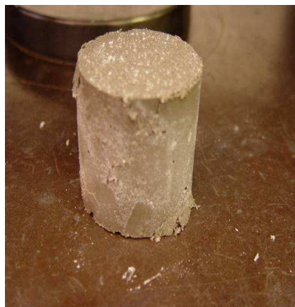
Figura 2.22 Ensayo de compresión sin confinamiento después de la destrucción para una lechada Well Life
