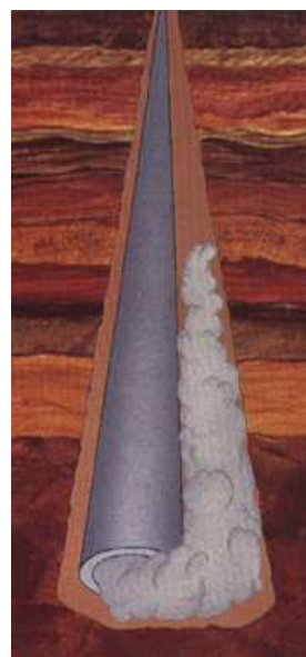
Figura 1.28 Efecto de péndulo en la tubería
