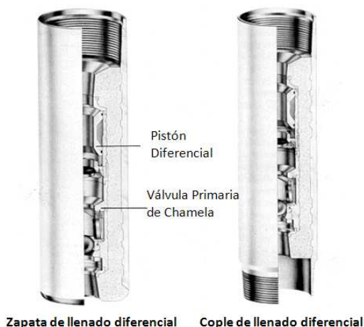
Figura 1.16 Dispositivos de Llenado Automático ó Diferencial (Zapatos y Collares)
