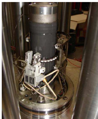
Figura 2.24 Muestra confinada con instrumentación
