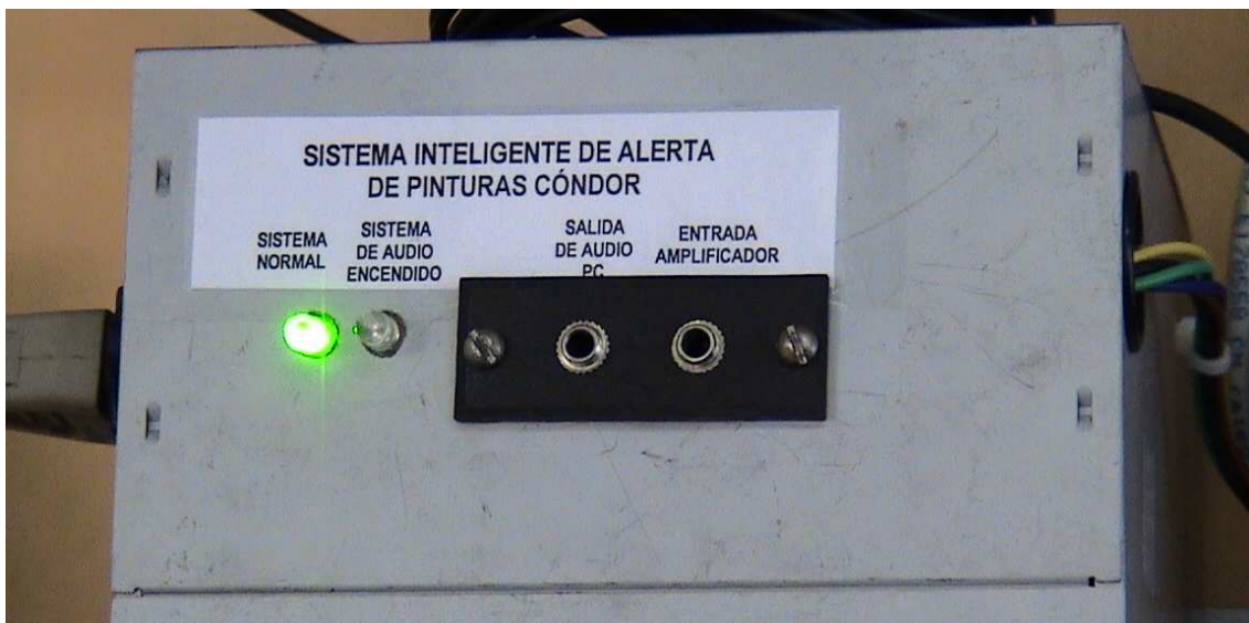
Figura 3.8 Caja metálica que contiene el hardware diseñado e implementado
