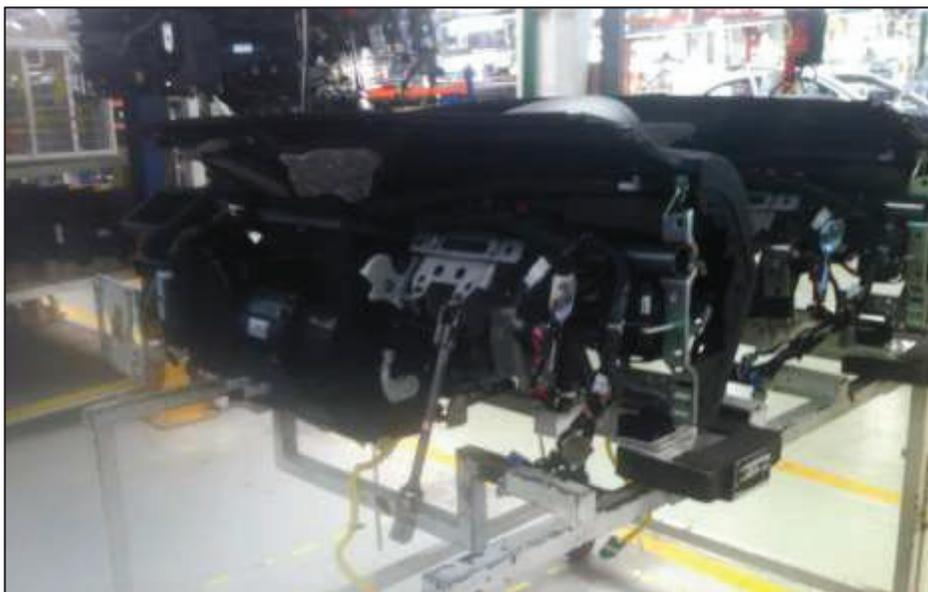
Figura 2.25. Rack de stock de tableros de instrumentos.
