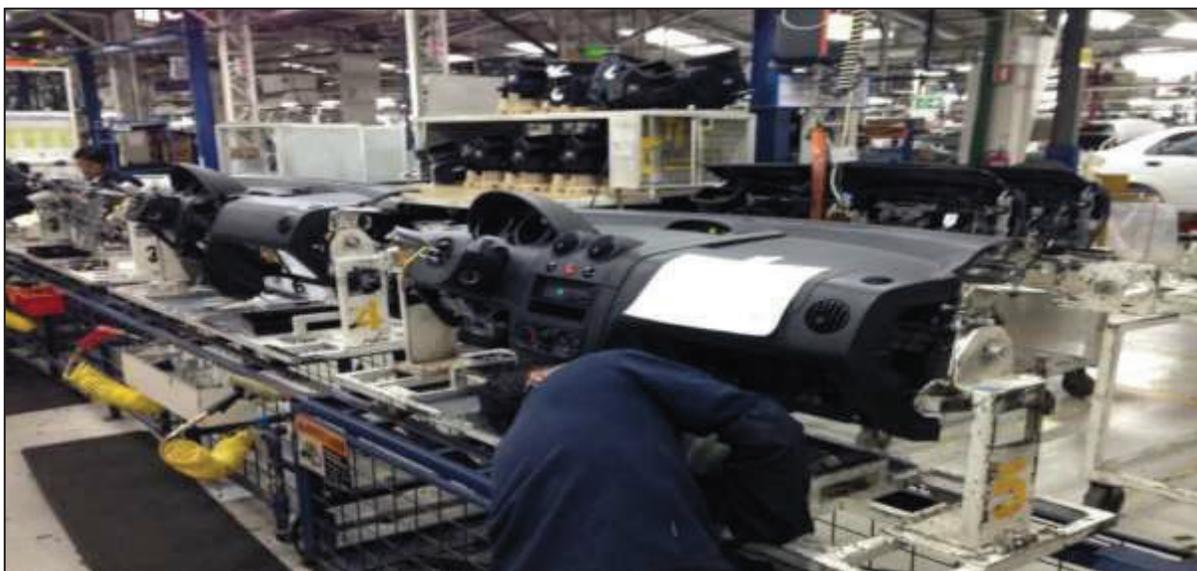
Figura 1.3. Subensamble de tableros de instrumentos de vehículos de pasajeros.
