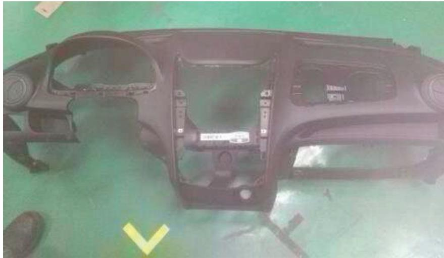
Figura A3.1. Carcasa armada del tablero de instrumentos del modelo ENGR41.
