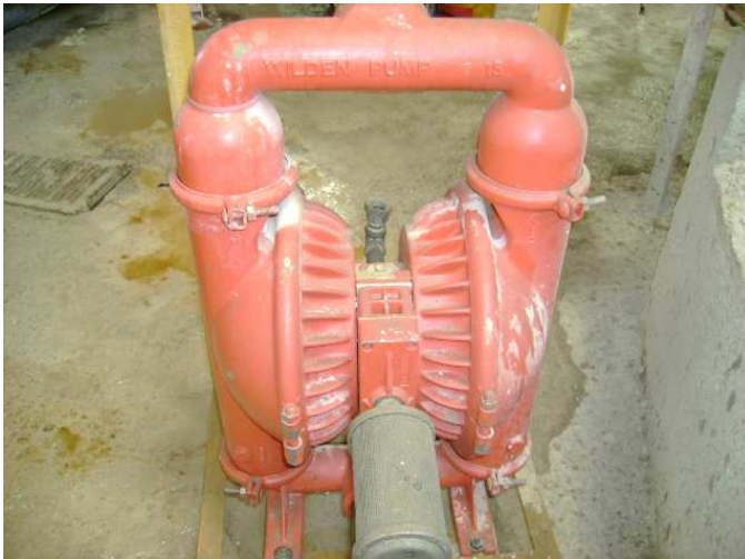
Fig.: 1.7 Sistema de bombeo Neumático
