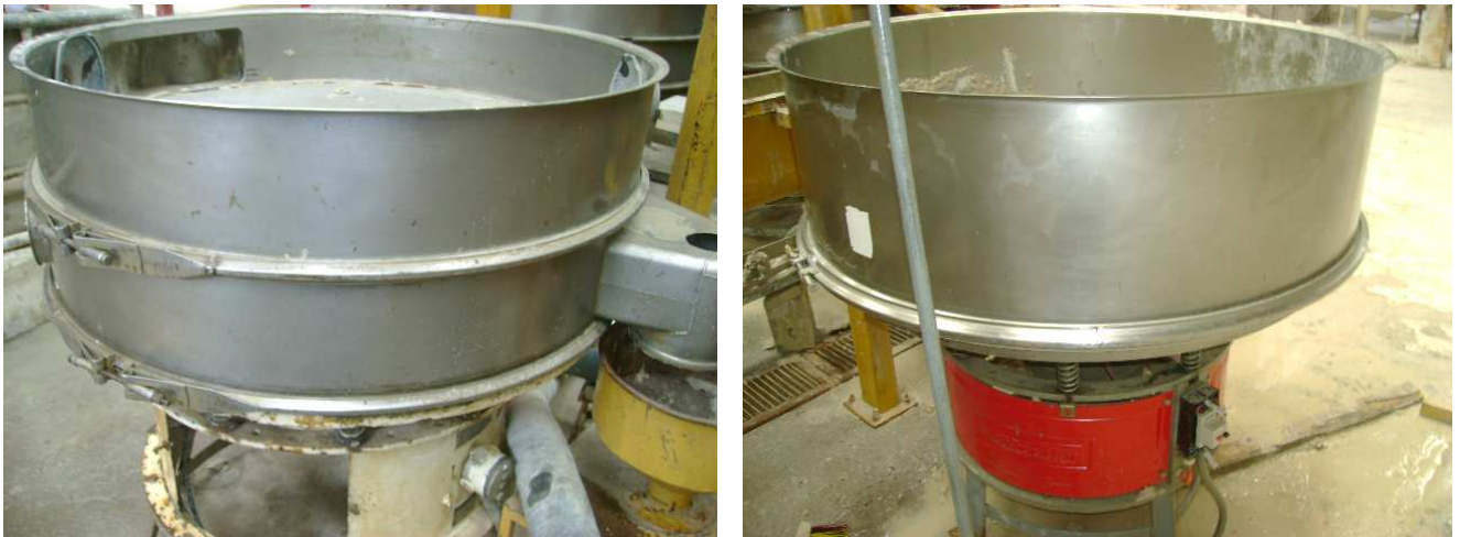
Fig.: 1.6 Sistema de Tamizado para cernir la pasta
