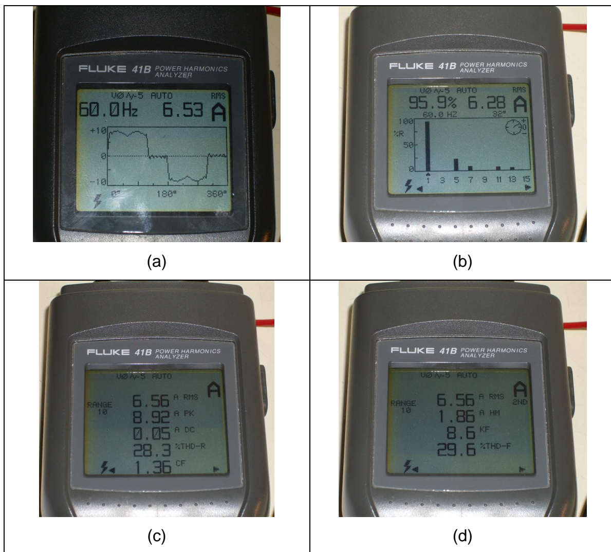
Figura 4.7 Análisis de la señal de 120V de la red de 60Hz: a) Forma de onda de la señal, b) Análisis armónico de la señal, c) y d) Valores RMS, pico y THD% de la señal de voltaje
