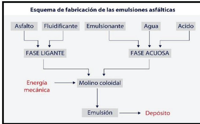
Ilustración 25 - Proceso general de elaboración de emulsión asfáltica
