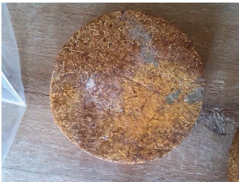
Figura AV. 2. Bloque contaminado
