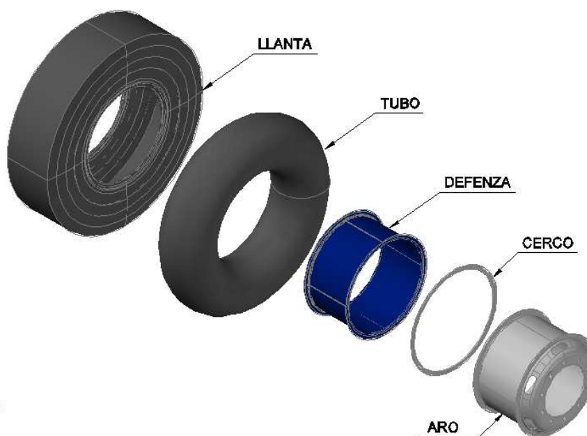
Fig. 1.2 Elementos componentes de la rueda de emergencia
