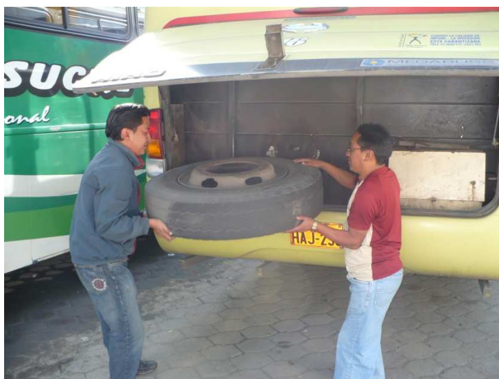
Fig. 2.1 Posicionamiento manual de la rueda de emergencia desde su depósito.
