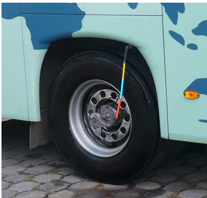
Fig. 1.3 Rueda con dispositivo para asistencia de aire comprimido.
