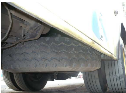
Fig. 2.6 Ubicación del mecanismo por tecle en la parte baja del vehículo.
