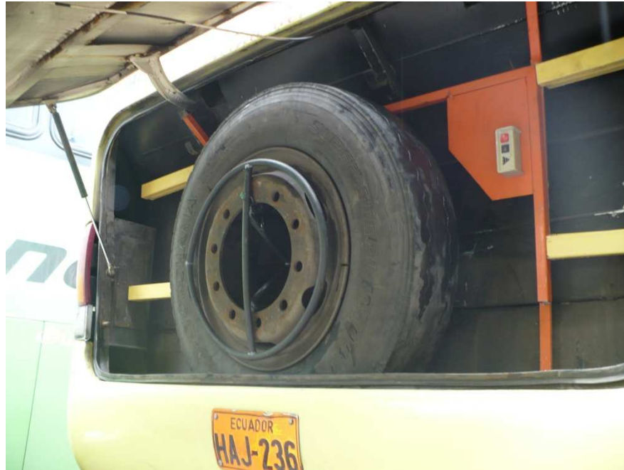
Figura 4.3 (a). Posición inicial del prototipo en el bus.
