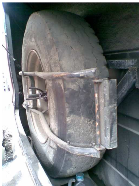
Fig. 2.2 Palanca tipo escalera para el posicionamiento de la rueda de emergencia.
