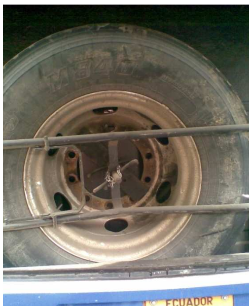
Fig. 2.3 Posicionamiento mediante palanca tipo escalera.
