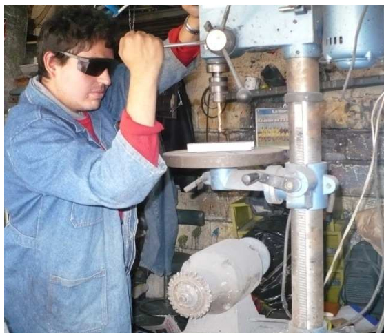
Figura 4.1(a). Fabricación del agujero interior del carrete
