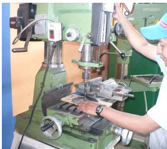
Figura 4.1 (b). Fabricación del agujero interior del carrete
