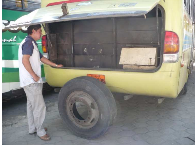
Fig. 1.4 Bodega para el almacenamiento de la rueda de emergencia.
