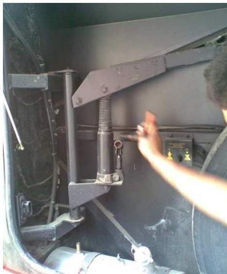
Fig. 2.4 Mecanismo de posicionamiento por grúa hidráulica.
