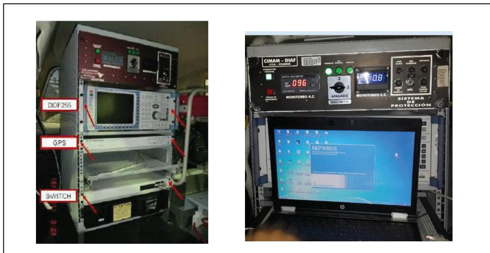
**Figura 2.8** Equipos internos de la Estación Móvil [29]
