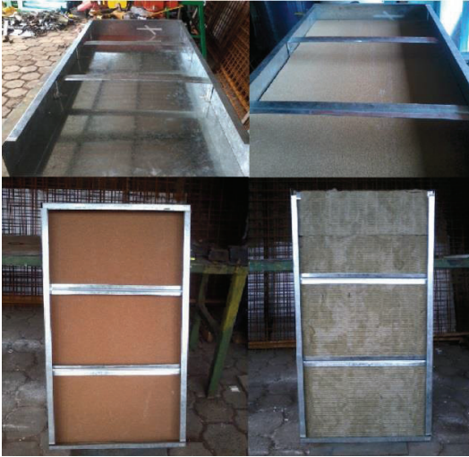
Figura 4. 7 Montaje del panel frontal, refuerzo acústico y material absorbente
