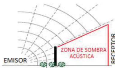
Figura 2. 9 Zona de sombra producida por la pantalla acústica
